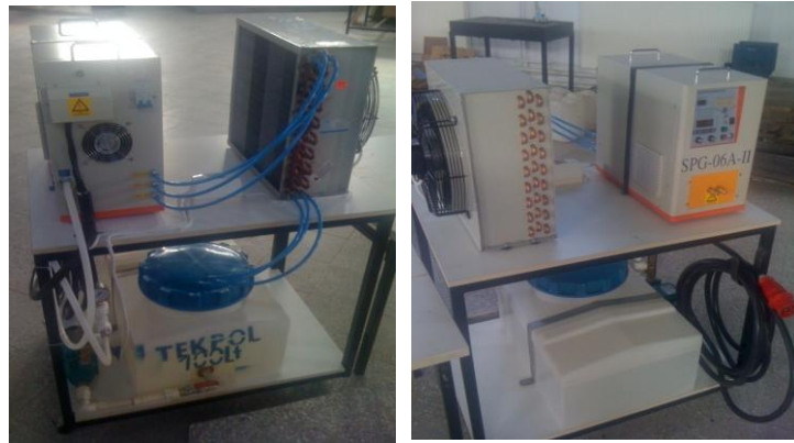
Şekil 3.4. İndüksiyon fırını ve soğutma tesisatı
