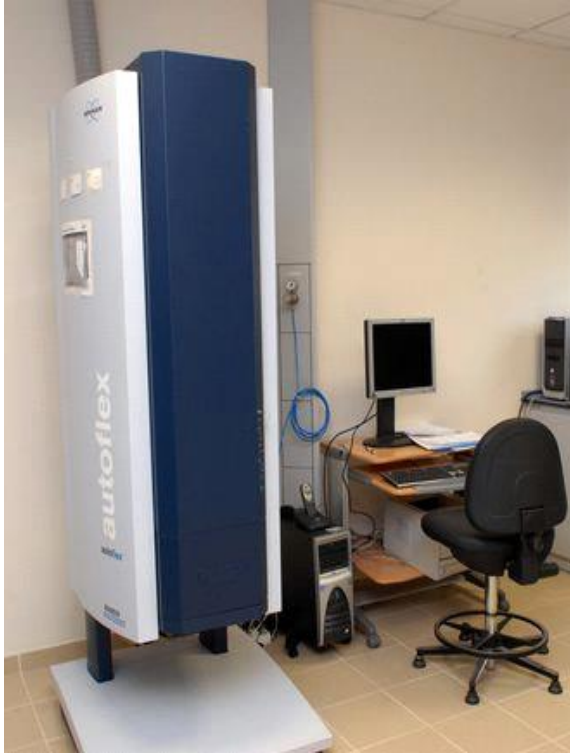
Şekil 1.10. MALDI-TOF cihazının genel görüntüsü ve numunelerin verildiği hedef (target) aparatı
