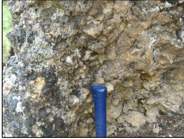
Şekil 3.49 Fay zonundaki breşleşmiş kireçtaşlarının yakından görünümü (Konum için şekil 3.48.b'ye bakınız)
