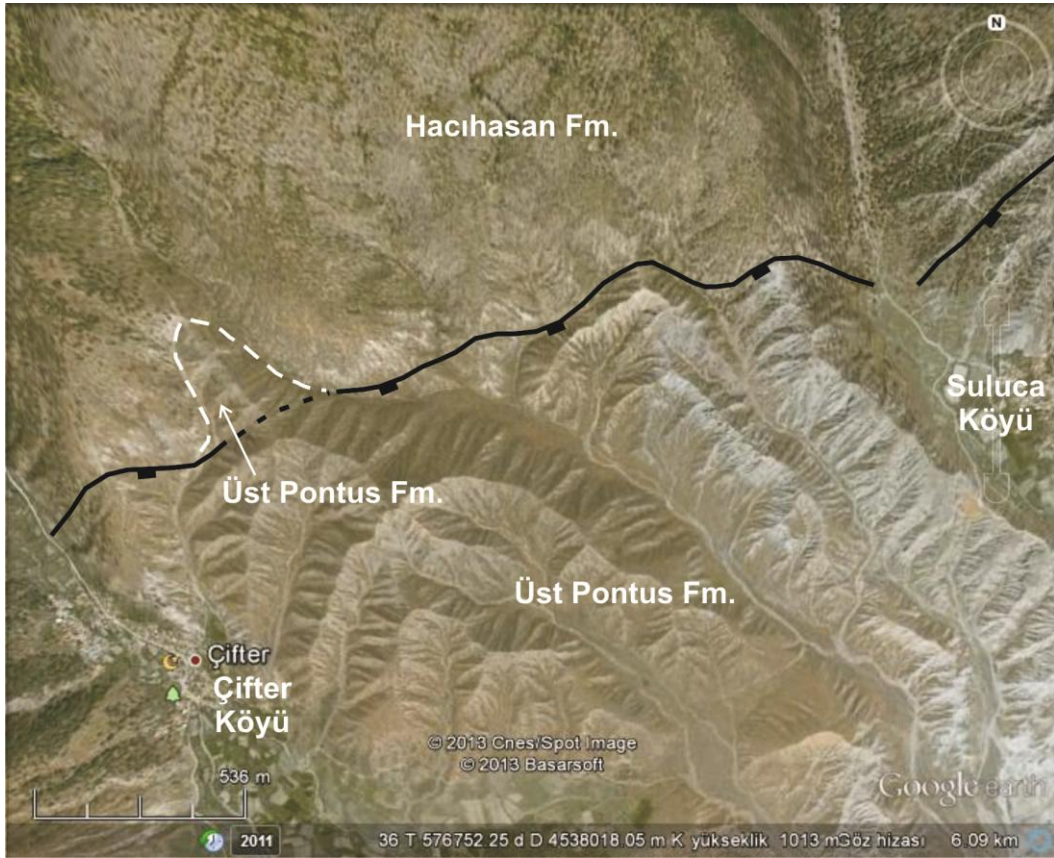
Şekil 3.39 Çifter köyü KD'sunda Tosya Fayı'nın Üst Pontus formasyonu tarafından üzerlendiği kesimin Google Earth görüntüsü (Konum için şekil 3.33'e bakınız)
