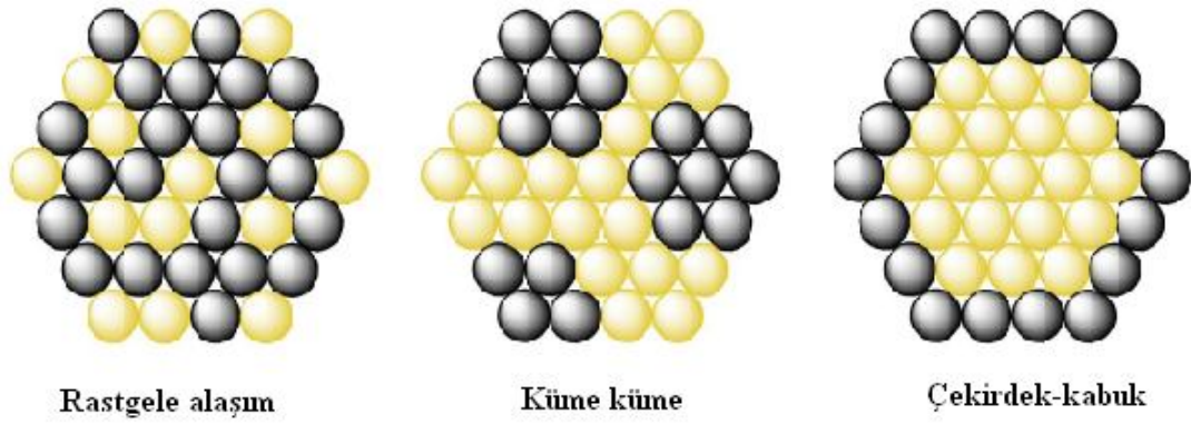
Şekil 2.16. Bimetalik nanopartiküllerin yaygın morfolojileri
