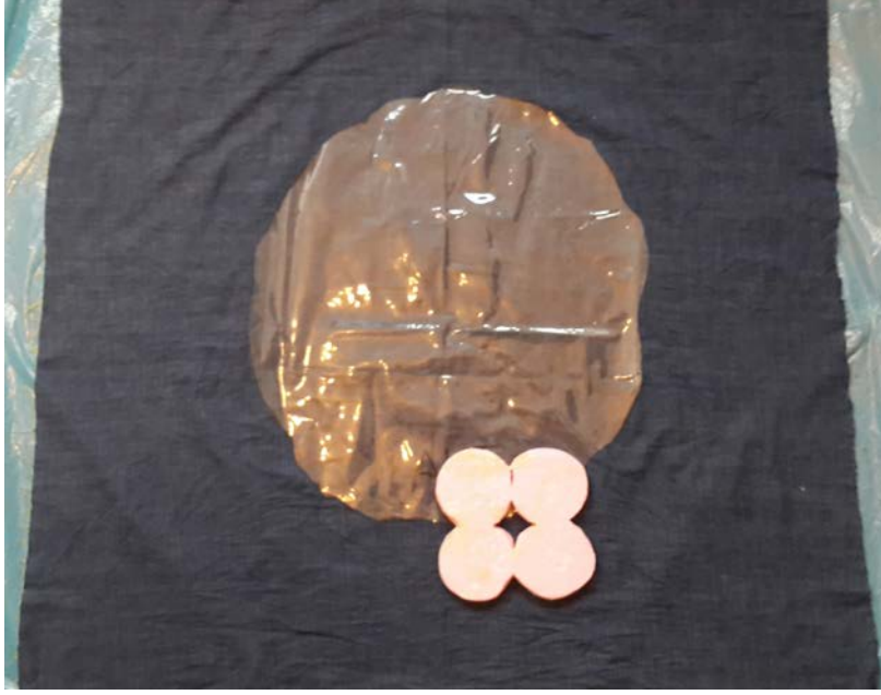
Resim 4.3.b. Boyanmış zemin üzerine kireç baskı aşaması.
