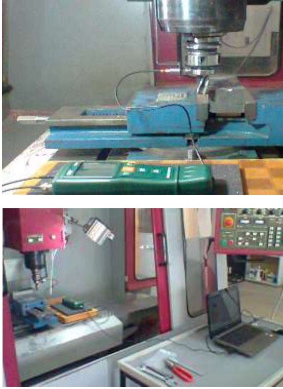
Şekil 5.9. Titreşim ölçüm cihazı ve bağlama görüntüleri
