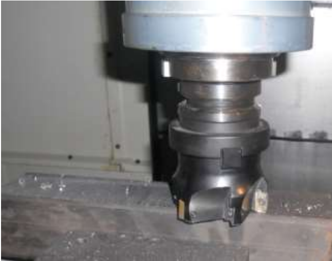
Şekil 5.1. Universal freze tezgahında yüzeyleri işlenmiş AISI 1040 deney numunesi
