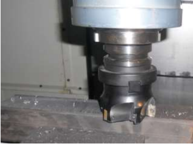
Şekil 5.1. Universal freze tezgahında yüzeyleri işlenmiş AISI 1040 deney numunesi
