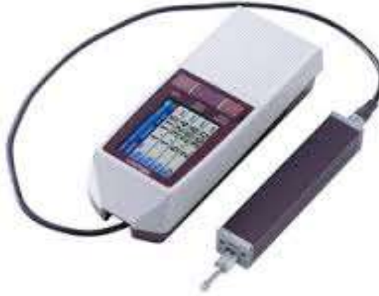
Şekil 5.7. Yüzey pürüzlülük ölçüm cihazı ( Mitutoyo (Surf test SJ-210) )
