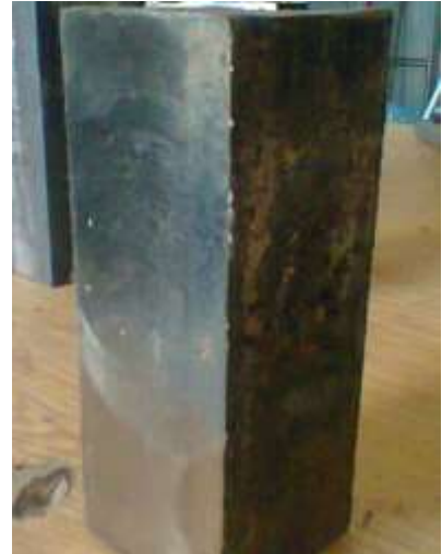
Şekil 5.1. Universal freze tezgahında yüzeyleri işlenmiş AISI 1040 deney numunesi
