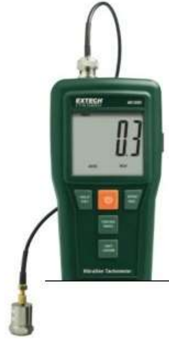
Şekil 5.9. Titreşim ölçüm cihazı ve bağlama görüntüleri
