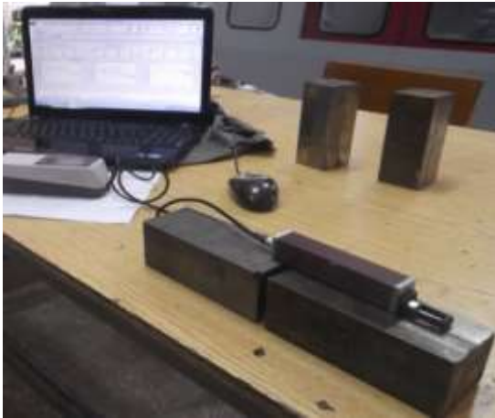
Şekil 5.8. Yüzey pürüzlülük ölçüm cihazı ile ölçüm alma
