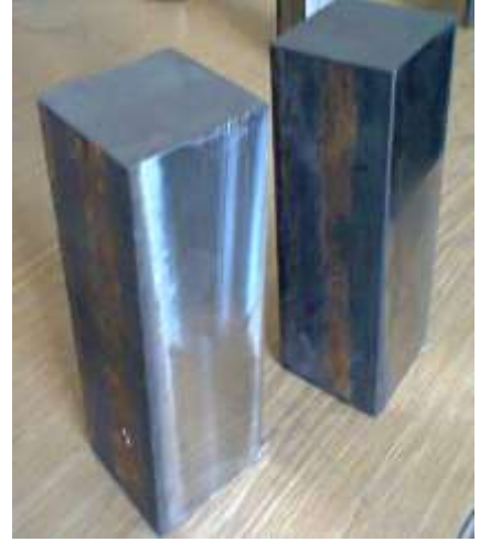
Şekil 5.1. Universal freze tezgahında yüzeyleri işlenmiş AISI 1040 deney numunesi
