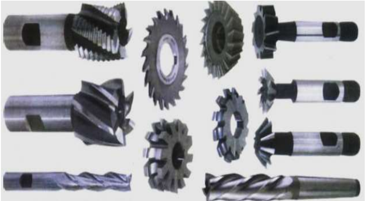
Şekil 2.4. Yüksek hız çeliğinden (HSS) yapılmış kesiciler
