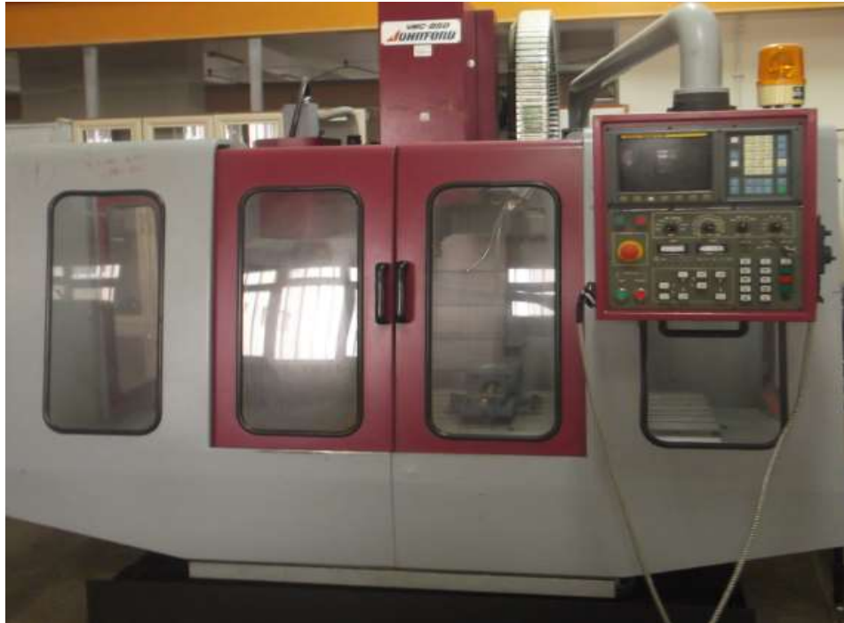
řekil 5.6. “Johnford VMC-550” Cnc freze tezgahı
