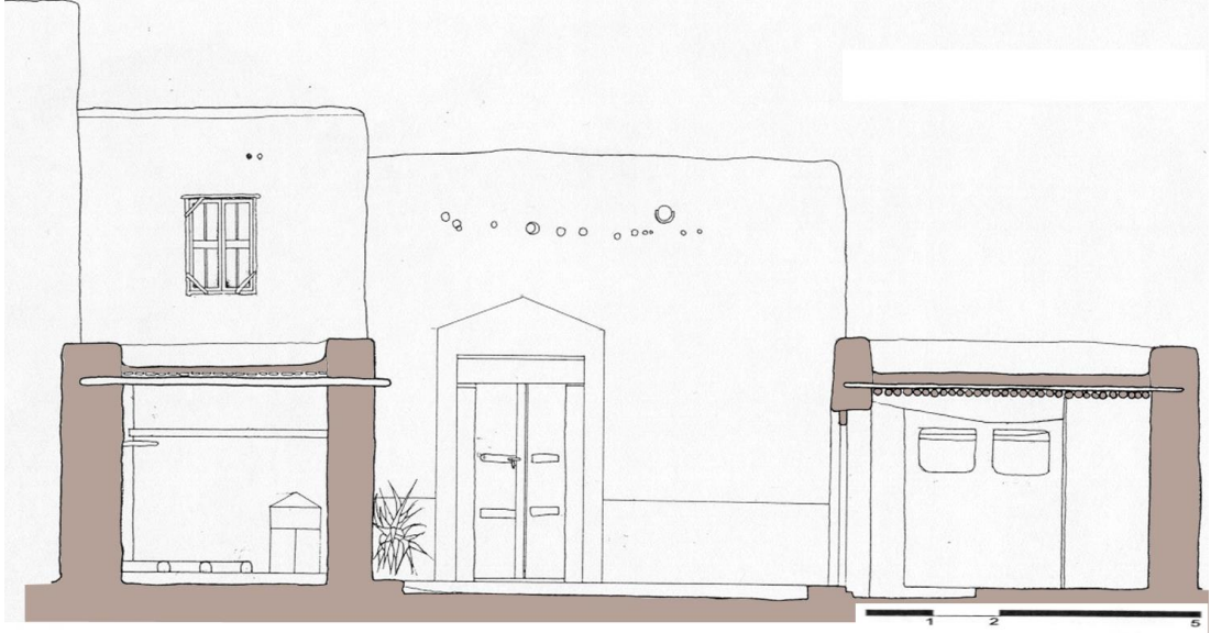
Resim 4.35: Mahdi hados evinin kesiti, ge gar tipinin örneği (HPNRS, 31 Ocak 2004)
