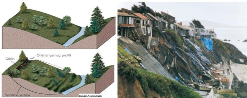
Şekil 3.11. Şev ve yamaç topuklarının sular tarafından oyulması ve şev yenilmesi (Monreo ve Wincender, 2005)
