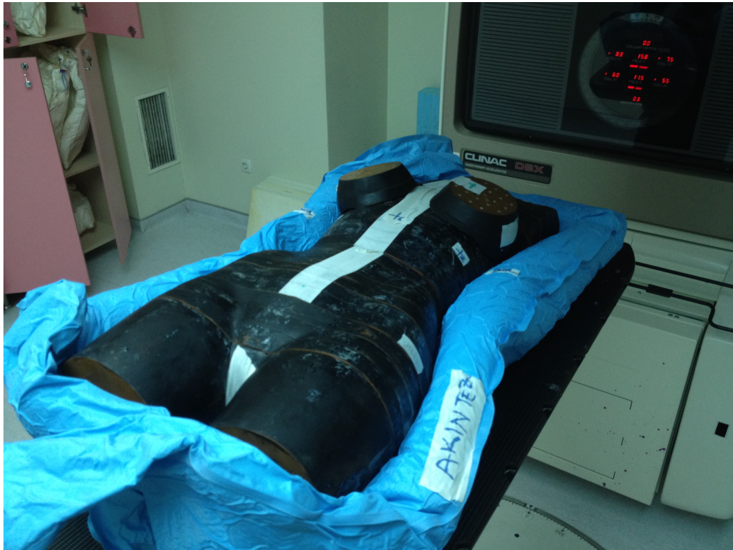
Şekil 15. Fantomun simülasyon ve tedavi için vakumlu yatağa yerleşimi
