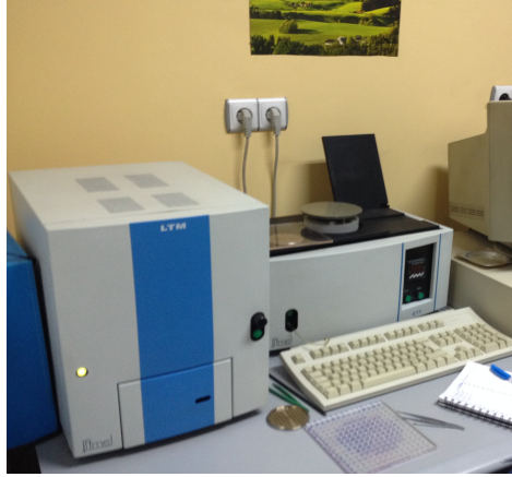
Şekil 8. TLD okuma ve fırınlama sistemi
