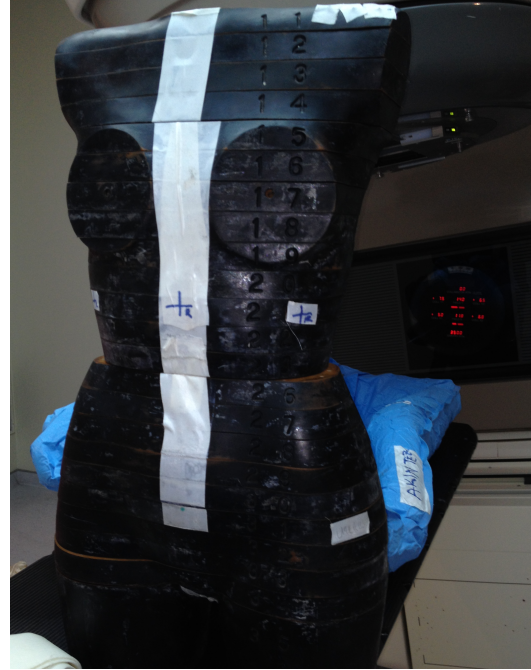
Şekil 23. Bel kısmından iki adet dilim çıkarılmış (5 cm daha kısa) fantom
