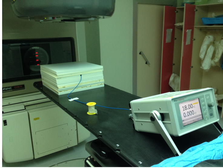
Şekil 10. Wellhöfer Dose 1 elektrometre günlük ölçüm esnasında
