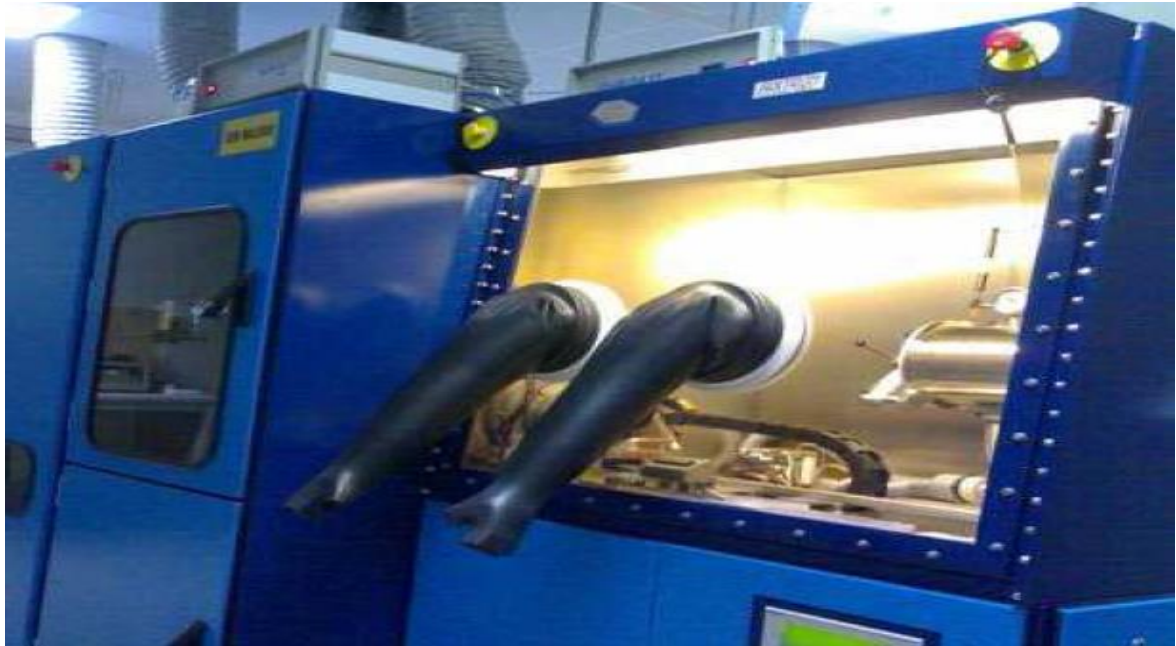
Resim 5.1. Bilkent Üniversitesi Nanoteknoloji Araştırma Merkezi bünyesinde kurulu olan AIXTRON RF200/4 RF-S GaN/AlGaIn MOVPE sistemi
