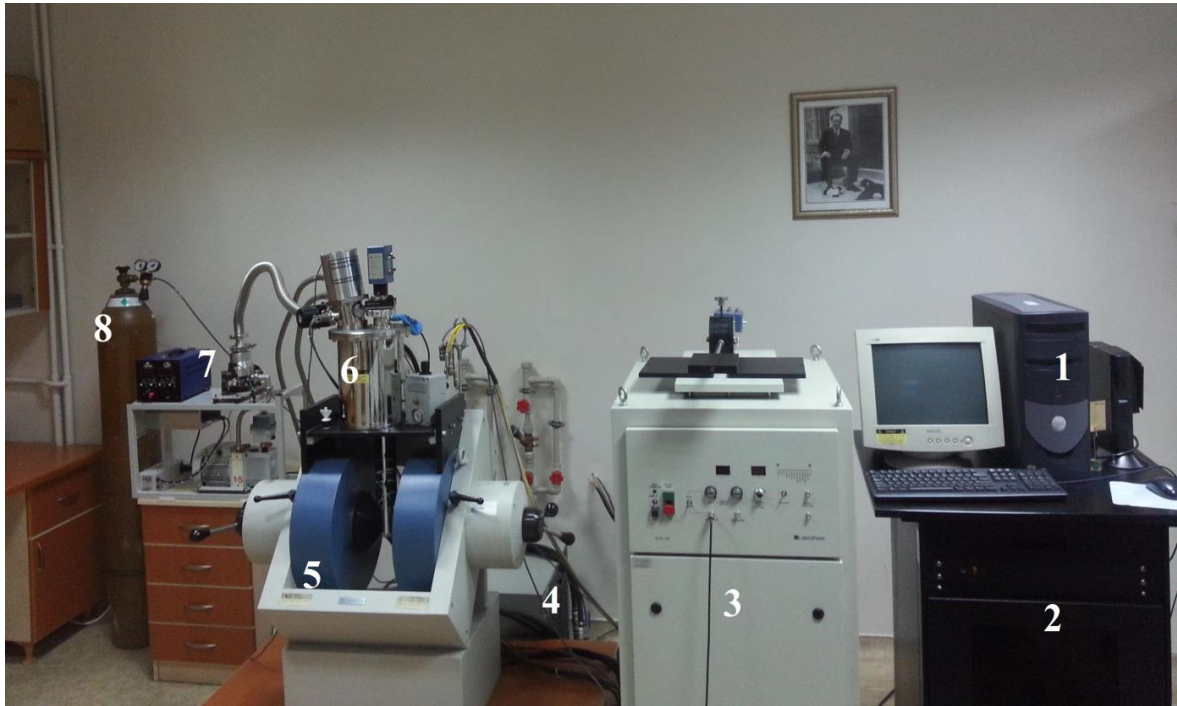
Resim 5.2. Lakeshore 7700 Yüksek Empedanslı Hall Etkisi ölçüm sistemi 1) Bilgisayar, 2) Sıcaklık Kontrol Ünitesi, 3) Elektromıknatıs Güç Kaynağı, 4) Kapalı devre Helyum soğutma sistemi, 5) Elektromıknatıs, 6) Kryostat, 7) Mekanik pompa destekli turbo moleküler vakum sistemi, 8) Helyum Tüpü
