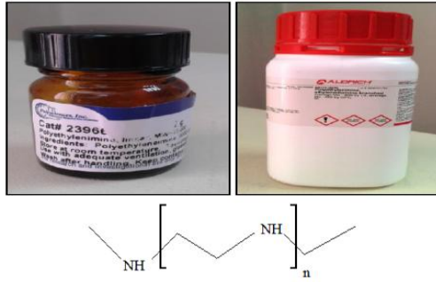
Şekil 3.3: Polietilenimin, lineer (PEI, lineer), Polietilenimin, dallanmış (PEI, dallanmış) ve molekül yapısı.
