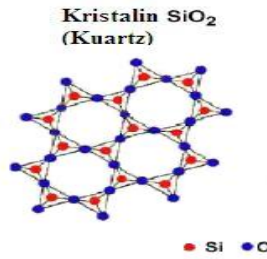
Şekil 2.15: Kuartz kristalinin molekül yapısı.
