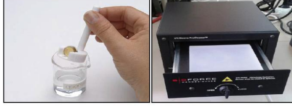
Şekil 3.13: Kuartz sensörün kimyasal işlemle ardından UV-Ozon işlemiyle temizlenmesine ait gösterim.
