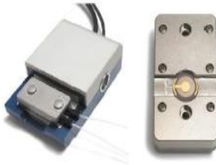
Şekil 2.12: Tek hücre içerisine yerleştirilmiş sensörün fotoğrafı.
