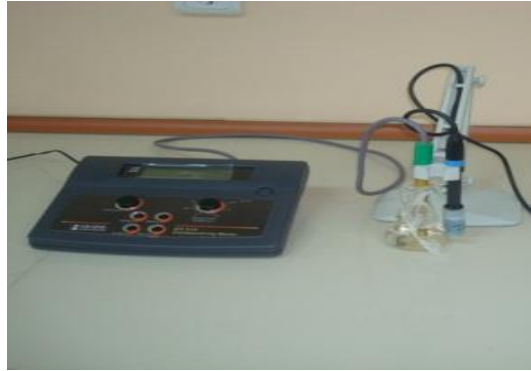
Şekil 3.11: HANNA Instruments HI 255 Combined Meter pH/mV & EC/TDS/NaCl marka pH metreye ait fotoğraf.
