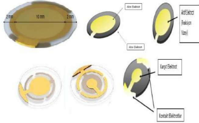
Şekil 2.11: Yüzeği altın kaplı kuartz sensörün ön ve arka tarafının görünüşü.
