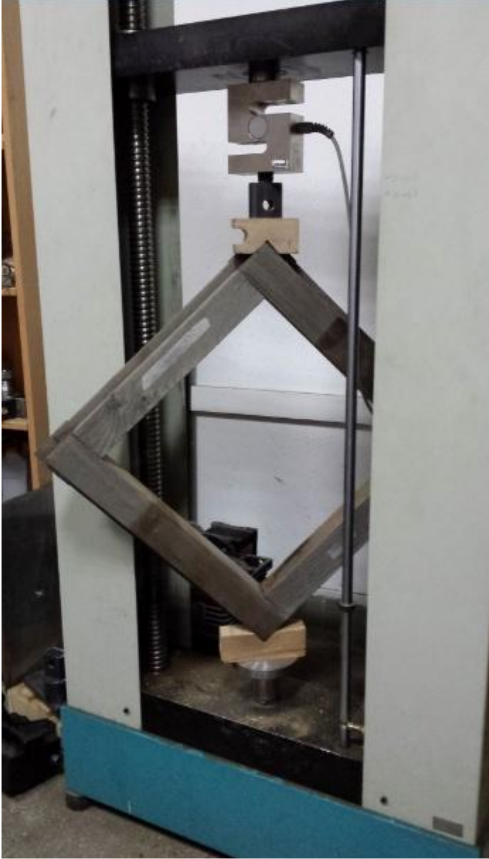
Resim 4.11. Tam çerçeve örneklerde diyagonal basınç deneyi
