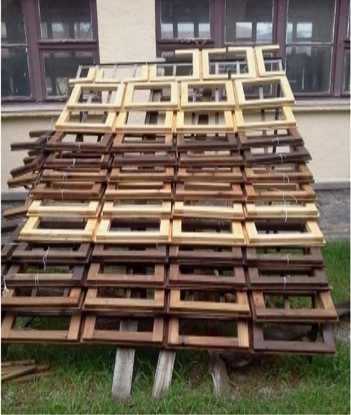
Resim 4.4. Deney örneklerinin açık hava şartlarında bekletilmesi ve platformun konumu
