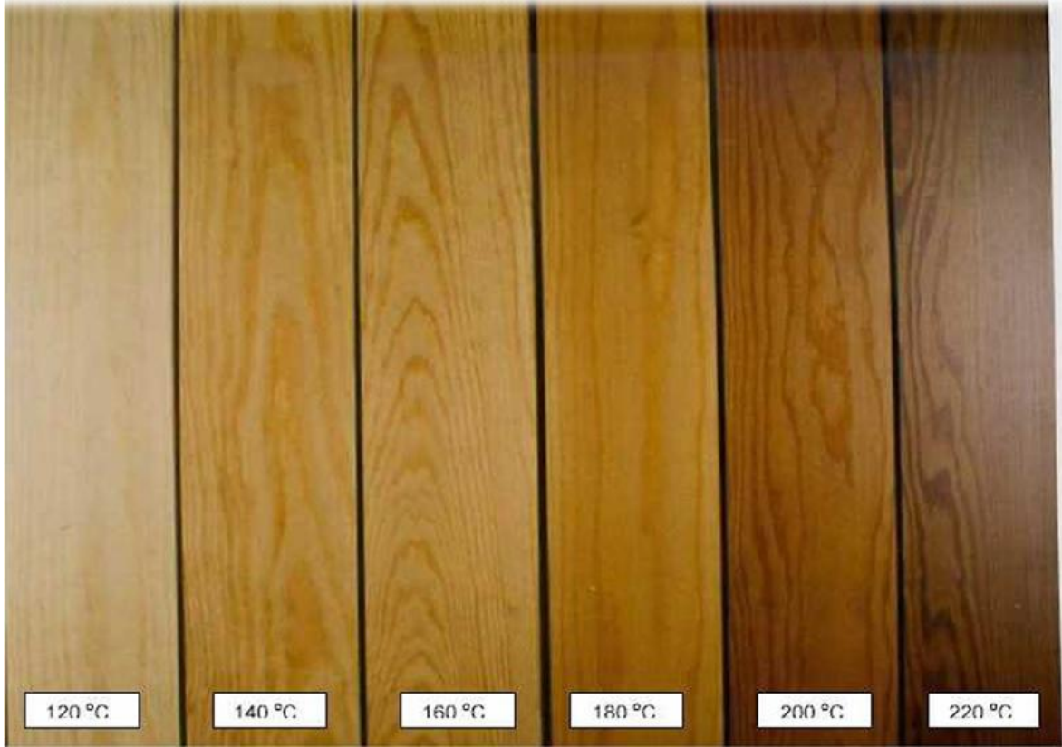
Resim 3.1. Termowood uygulamasının ısı ile doğru orantılı olarak ağaç malzemedeki renk değişimine etkisi[53]
