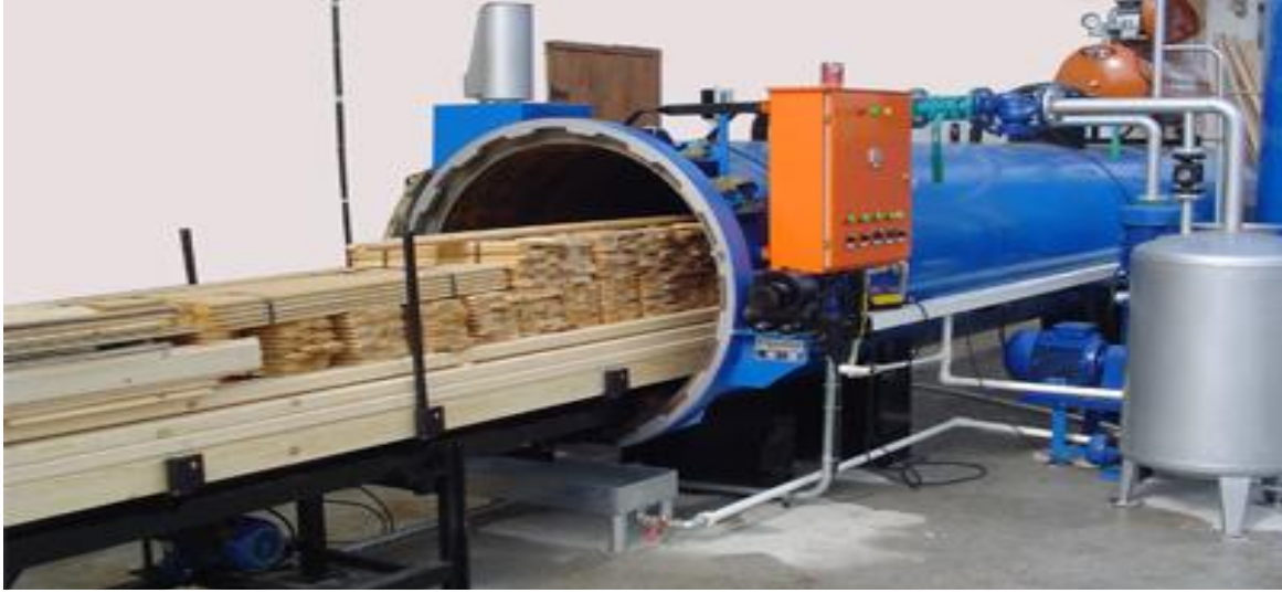
Resim 3.2. Yüksek basınca dayanıklı silindirik kazanlarda gerçekleştirilen vakum-basınç düzeneği
