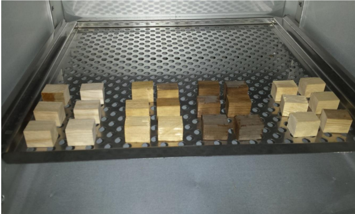
Resim 4.8. Yoğunluk ve retensiyon tayini için hazırlanan numuneler
