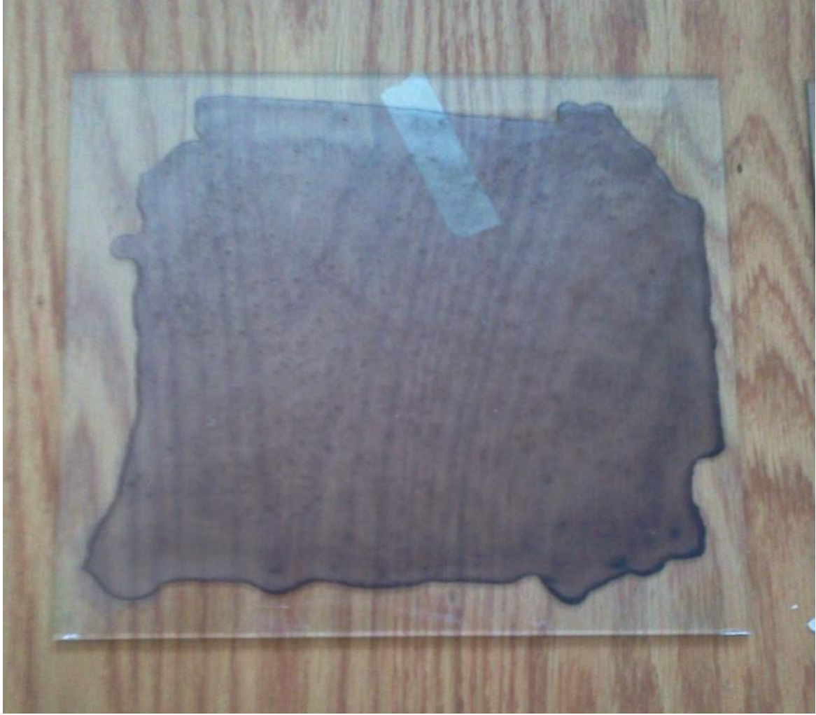
Resim 4.2. Oluşturulan çözeltinin katman yapma özelliğinin cam üzerindeki görünüşü
