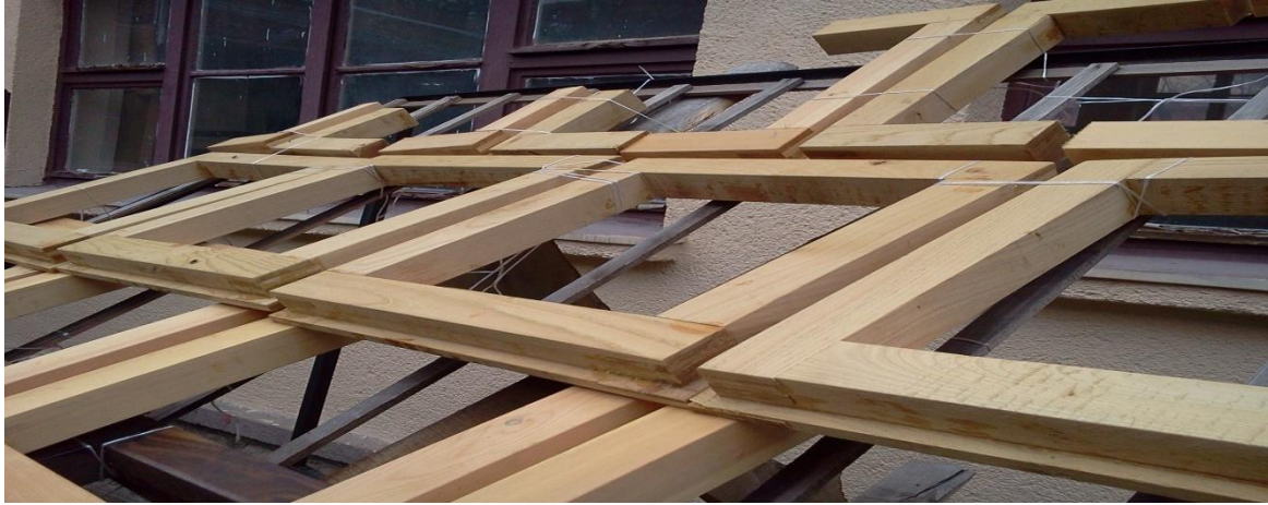
Resim 4.5. Deney örneklerinin açık hava şartlarında bekletilmesi
