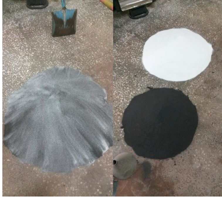
Şekil 4.27 Kuvars ve manyetit cevherinden oluşan yapay karışım numunesi
