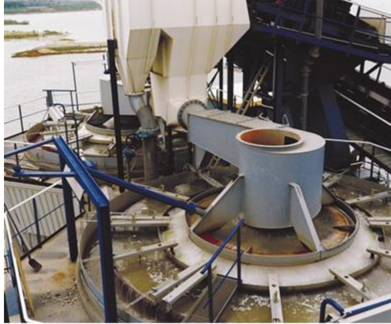
Şekil 3.9 Endüstriyel boyutlu bir Allflux sınıflandırıcıya ait fotoğraf görüntüsü
