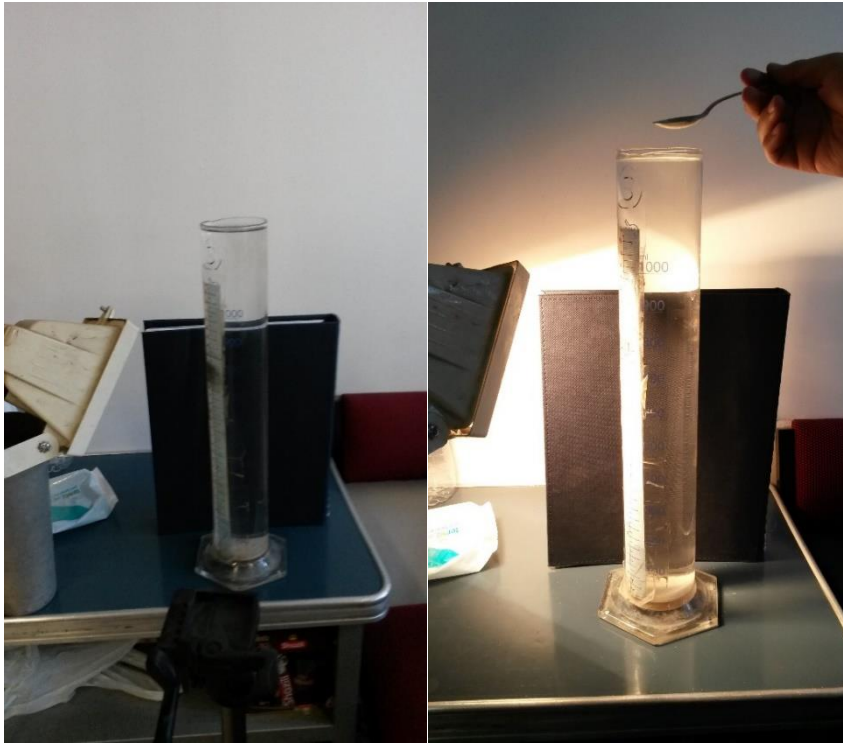
Şekil 4.5 Terminal çökme hızı hesaplamalarında kullanılan deney düzeneği
