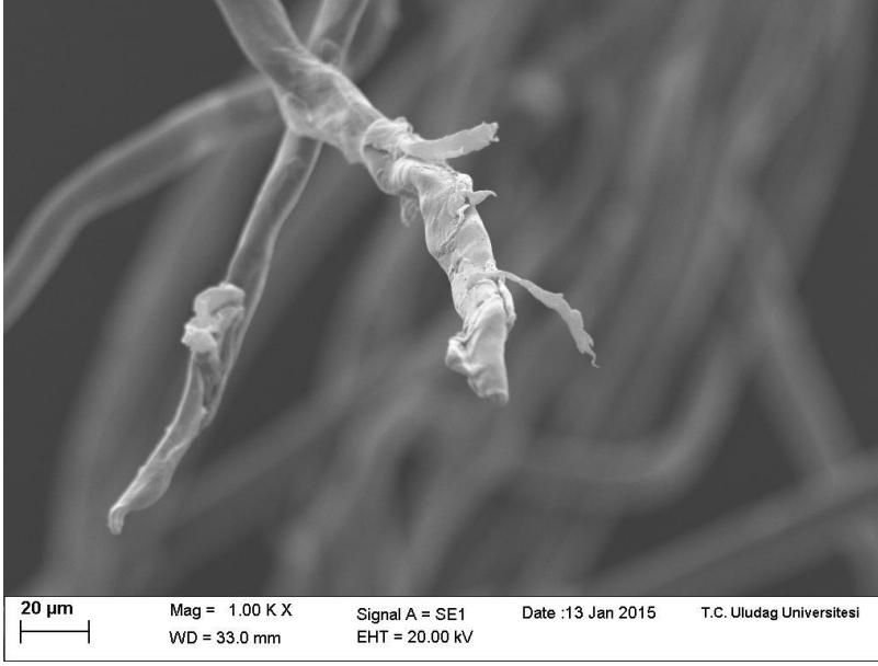
Şekil 8.28.(d) 3000 rpm Makine Devri, 3 Nolu Döşemelik Kumaşın Dikiş Uygulamasından Sökülen 150 tex PES/PES Üst Dikiş İpliği SEM Görüntüsü (1000 X)
