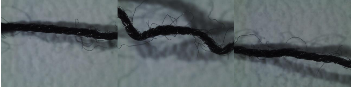
EK 2 Şekil 244. 152x3 dtex EK 2 Şekil 245. 152x3 dtex EK 2 Şekil 246. 152x3 dtex Yağlanmamış PES Alt İplik Yağlanmamış PES Üst İplik Yağlanmamış PES Alt İplik 2. Nolu Kumaş, 2000 rpm 3. Nolu Kumaş, 2000 rpm 3. Nolu Kumaş, 2000 rpm
