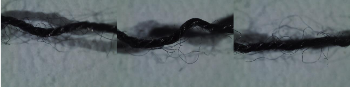
EK 2 Şekil 217. 152x3 dtex EK 2 Şekil 218. 152x3 dtex EK 2 Şekil 219. 152x3 dtex Yağlanmış PES Üst İplik Yağlanmış PES Alt İplik Yağlanmış PES Üst İplik 4. Nolu Kumaş, 1000 rpm 4. Nolu Kumaş, 1000 rpm 5. Nolu Kumaş, 1000 rpm
