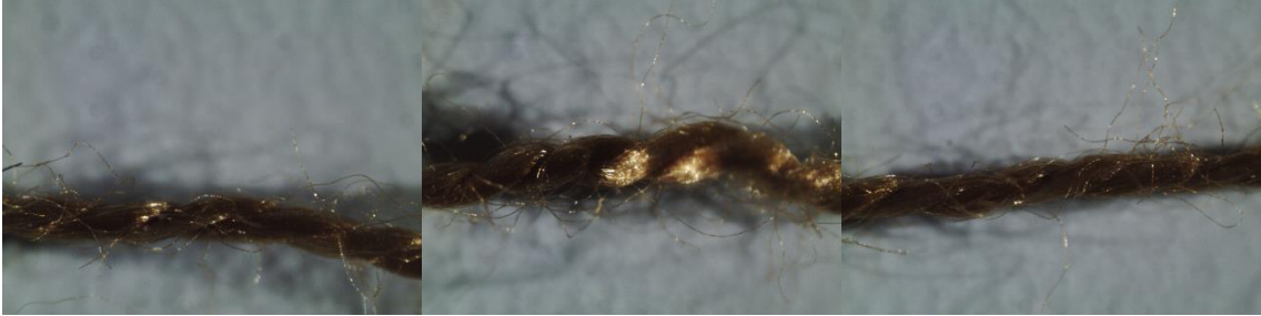
EK 2 Şekil 430.105 tex EK 2 Şekil 431.105 tex EK 2 Şekil 432.105 tex PES/PES Alt İplik 2. Nolu PES/PES üstt iplik 3. Nolu PES/PES Üst İplik 3. Nolu Denim Kumaş, 3000 rpm Denim Kumaş, 3000 rpm Denim Kumaş, 3000 rpm
