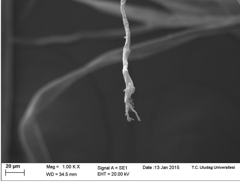
Şekil 8.23.(c) 3000 rpm Makine Devri, 3 Nolu Denim Kumaşın Dikiş Uygulamasından Sökülen 105 tex PES/CO Üst Dikiş İpliği SEM Görüntüsü (1000 X)
