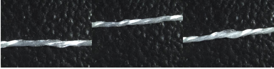
EK 2 Şekil 181. 138x3 dtex EK 2 Şekil 182. 138x3 dtex EK 2 Şekil 183. 138x3 dtex Yağlanmamış PES Üst İplik Yağlanmamış PES Alt İplik Yağlanmamış PES Üst İplik 1. Nolu Kumaş, 2000 rpm 1. Nolu Kumaş, 2000 rpm 2. Nolu Kumaş, 2000 rpm
