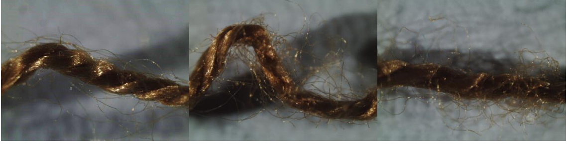
EK 2 Şekil 442.150 tex EK 2 Şekil 443.150 tex EK 2 Şekil 444.150 tex PES/PES Alt İplik 2. Nolu PES/PES Üst İplik 3. Nolu PES/PES Alt İplik 3. Nolu Denim Kumaş, 3000 rpm Denim Kumaş, 3000 rpm Denim Kumaş, 3000 rpm
