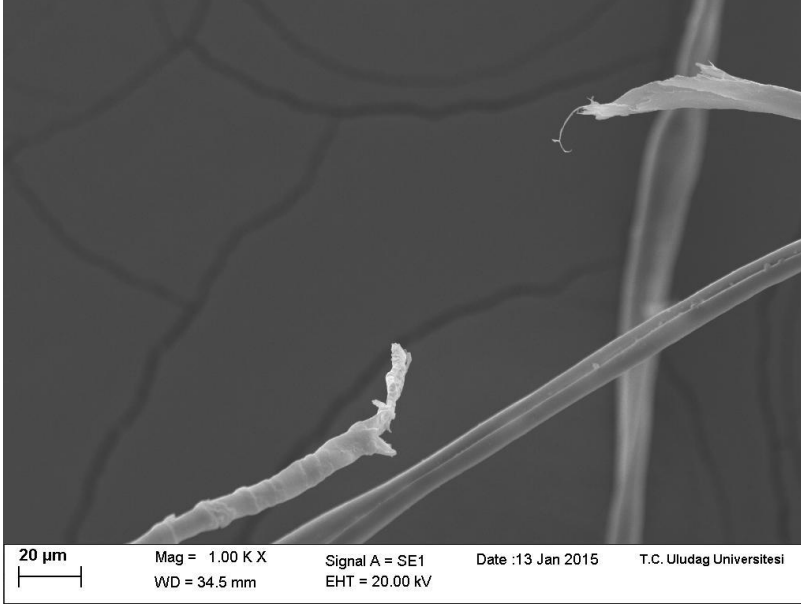
Şekil 8.22.(c) 3000 rpm Makine Devri, 4 Nolu Döşemelik Kumaşın Dikiş Uygulamasından Sökülen 105 tex PES/CO Üst Dikiş İpliği SEM Görüntüsü (1000 X)
