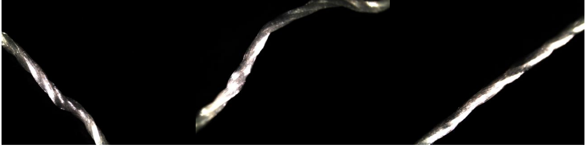
EK 2 Şekil 199. 138x3 dtex EK 2 Şekil 200. 138x3 dtex EK 2 Şekil 201. 138x3 dtex Yağlanmış PES Üst İplik Yağlanmış PES Alt İplik Yağlanmamış PES Üst İplik 5. Nolu Kumaş, 3000 rpm 5. Nolu Kumaş, 3000 rpm 1. Nolu Kumaş, 3000 rpm
