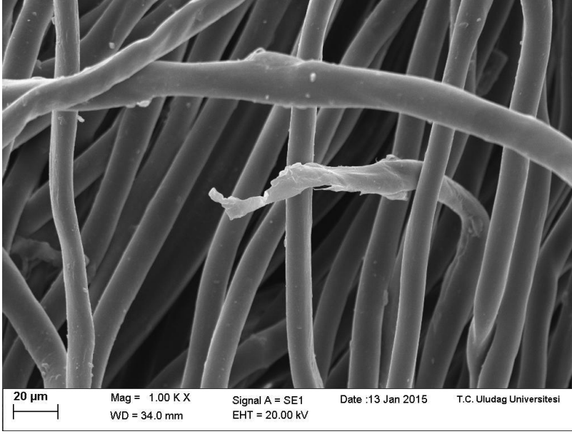
Şekil 8.26.(d) 3000 rpm Makine Devri, 4 Nolu Döşemelik Kumaşın Dikiş Uygulamasından Sökülen 150 tex PES/PES Üst Dikiş İpliği SEM Görüntüsü (1000 X)
