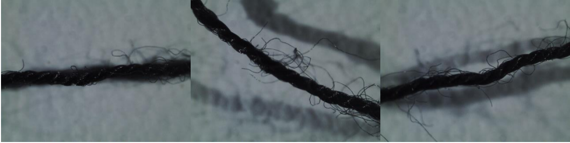
EK 2 Şekil 220. 152x3 dtex EK 2 Şekil 221. 152x3 dtex EK 2 Şekil 222. 152x3 dtex Yağlanmış PES Alt İplik Yağlanmamış PES Üst İplik Yağlanmamış PES Alt İplik 5. Nolu Kumaş, 1000 rpm 1. Nolu Kumaş, 1000 rpm 1. Nolu Kumaş, 1000 rpm
