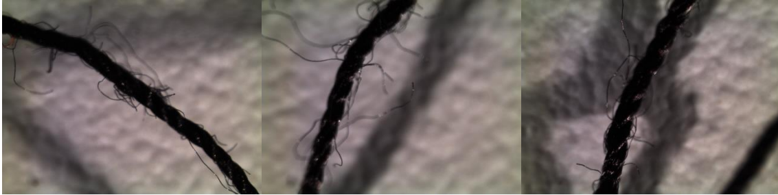
EK 2 Şekil 268. 152x3 dtex EK 2 Şekil 269. 152x3 dtex EK 2 Şekil 270. 152x3 dtex Yağlanmamış PES Alt İplik Yağlanmamış PES Üst İplik Yağlanmamış PES Alt İplik 4. Nolu Kumaş, 3000 rpm 5. Nolu Kumaş, 3000 rpm 5. Nolu Kumaş, 3000 rpm
