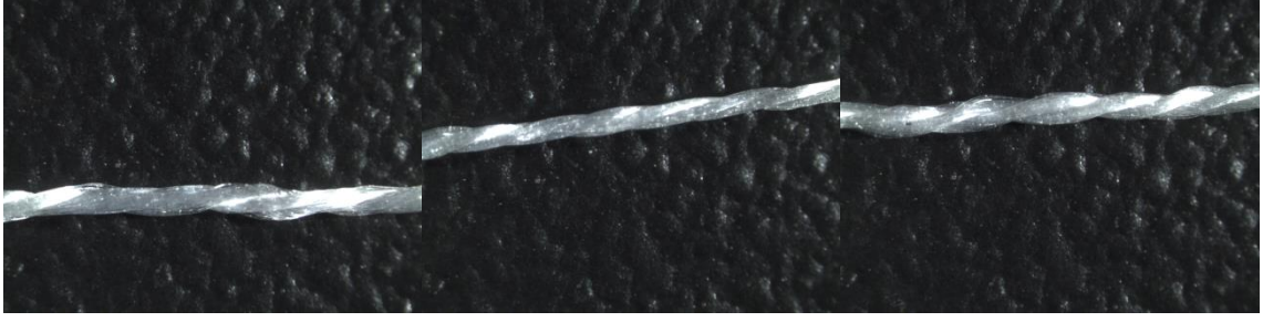
EK 2 Şekil 163. 138x3 dtex EK 2 Şekil 164. 138x3 dtex EK 2 Şekil 165. 138x3 dtex Yağlanmamış PES Üst İplik Yağlanmamış PES Alt İplik Yağlanmamış PES Üst İplik 2. Nolu Kumaş, 1000 rpm 2. Nolu Kumaş, 1000 rpm 3. Nolu Kumaş, 1000 rpm
