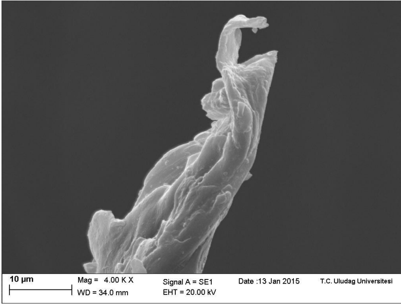
Şekil 8.28.(e) 3000 rpm Makine Devri, 3 Nolu Döşemelik Kumaşın Dikiş Uygulamasından Sökülen 150 tex PES/PES Üst Dikiş İpliği SEM Görüntüsü (4000 X)
