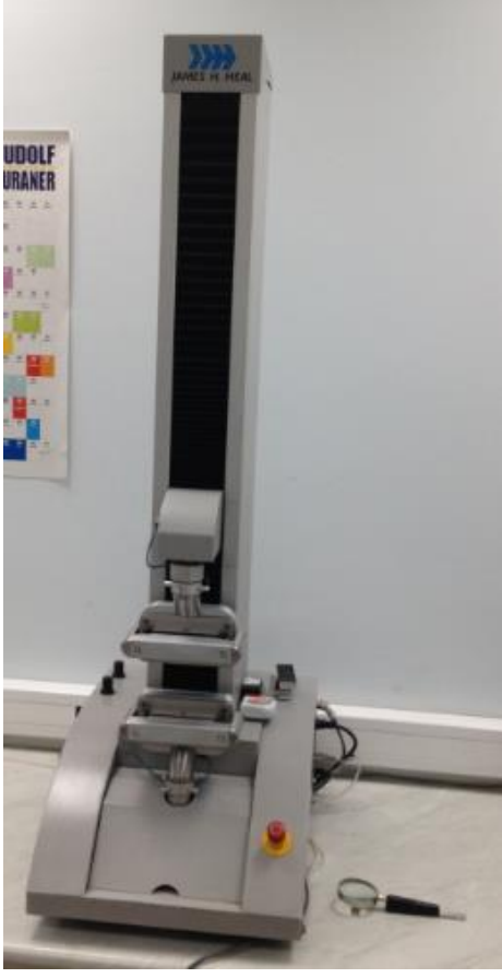
Şekil 8.6. James H. Heal Dikiş Kayma Test Cihazı
