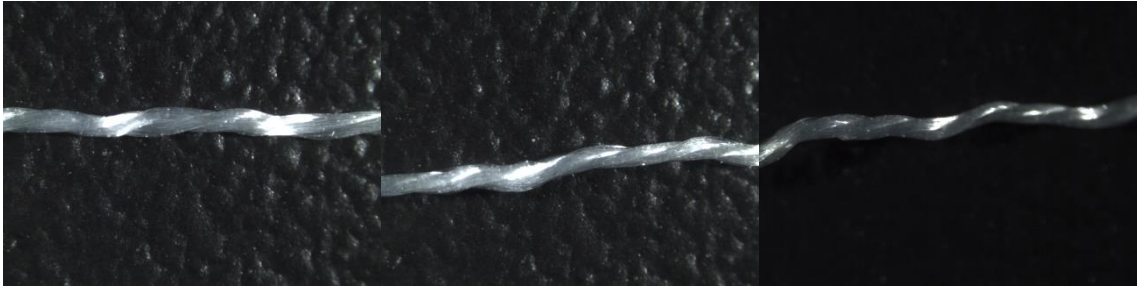
EK 2 Şekil 184. 138x3 dtex EK 2 Şekil 185. 138x3 dtex EK 2 Şekil 186. 138x3 dtex Yağlanmamış PES Alt İplik Yağlanmamış PES Üst İplik Yağlanmamış PES Alt İplik 2. Nolu Kumaş, 2000 rpm 3. Nolu Kumaş, 2000 rpm 3. Nolu Kumaş, 2000 rpm
