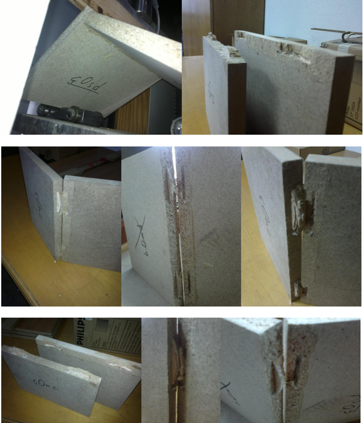
Resim 6.2. “L” tipi bisküvi birleştirmelerde çekme deneylerinde deformasyon örnekleri
