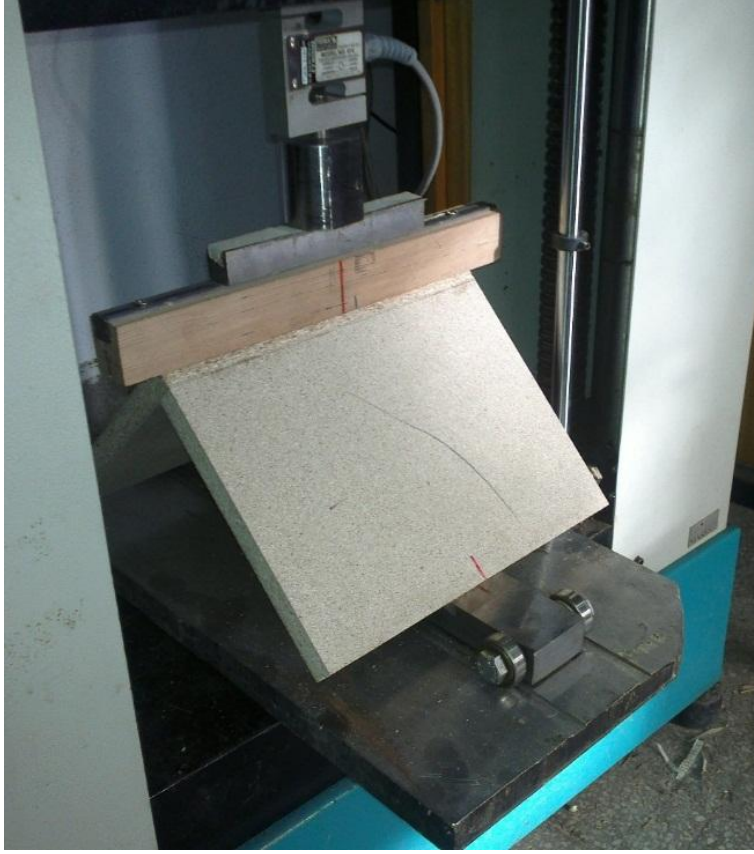
Resim 5.4. Diyagonal çekme deney düzeneği - 1
