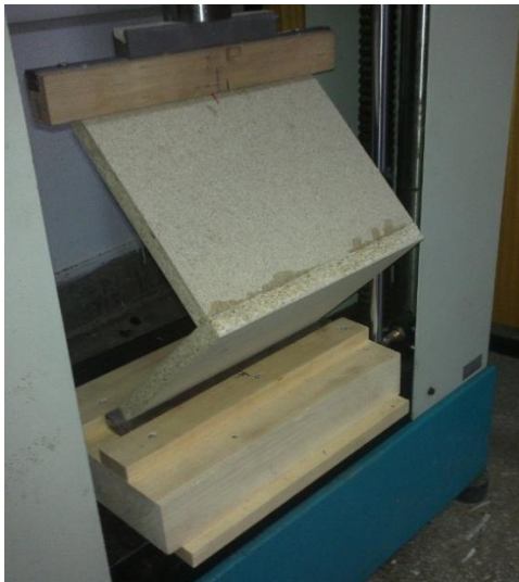
Resim 5.3. Diyagonal basınç deney düzeneği - 1
