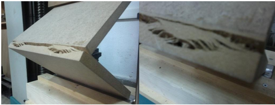
Resim 6.1. “L” tipi bisküvi birleştirmelerde basınç deneylerinde deformasyon örnekleri
