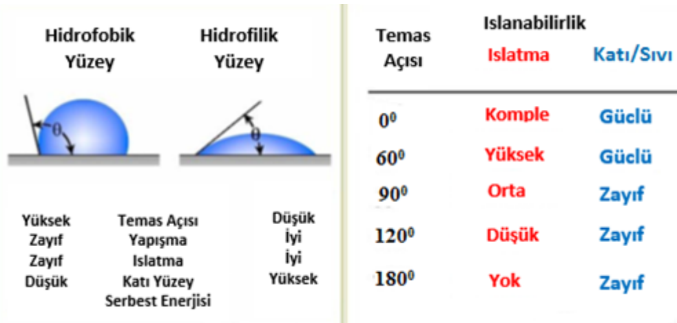
Şekil 1.6. Hidrofilik ve Hidrofobik özellikler (Ratner ve ark, 2004.)
