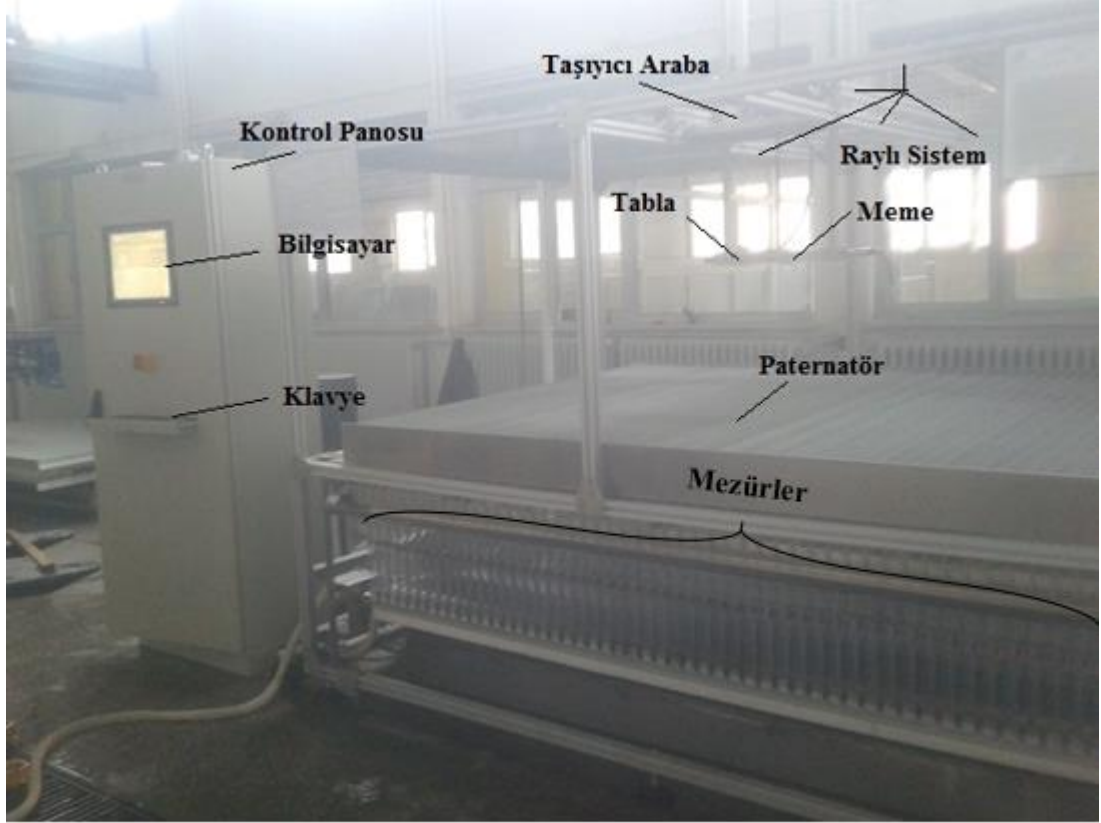
Şekil 3.13. Tek Meme Test Cihazı ve Ölçüm Sırasında Monitörden Alınan Bir Görüntü
