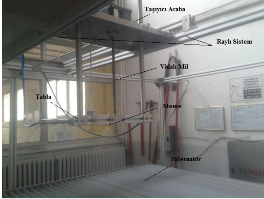
Şekil 3.33. Tek Meme Test Cihazına Ait Bir Görüntü
