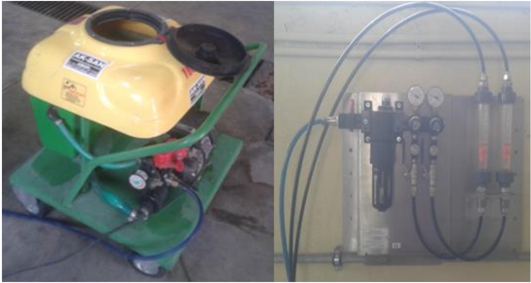
Şekil 3.19. Damla Analizinde Kullanılan Depo ve Merceklere Püskürtülen Hava Kumanda Ünitesi
