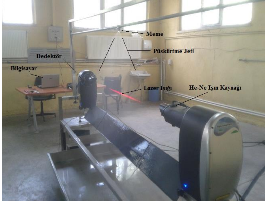
Şekil 3.35. Malvern Spraytec Cihazının Çalışması
