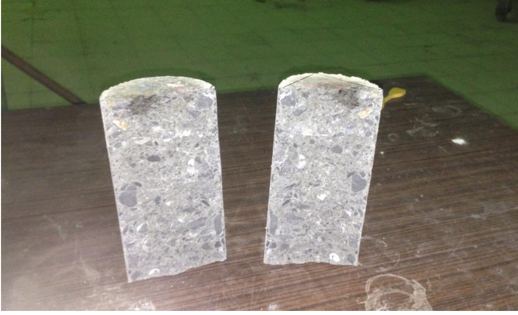
Şekil C.1: Lif içermeyen silindir şeklindeki numunenin yarma çekme deneyi sonrası görünüşü.
