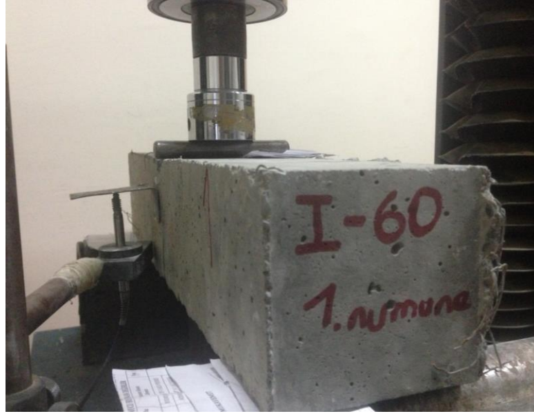
Şekil C.3: 60 kg/m 3 çelik lif içeren bir numunenin eğilme deneyi ve deplasman ölçer.
