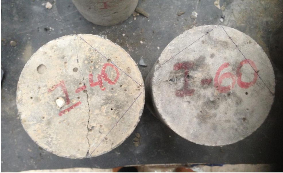
Şekil C.2: Lif içeren silindir şeklindeki numunenin yarma çekme deneyi sonrası görünüşü.
