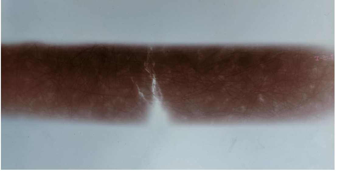
Şekil G.1: 20 kg/m 3 çelik lif içeren bir numunenin lif dağılımının ve çatlak ilerleyişinin yandan görünüşü ( G_f = 3408,89 N/m).
