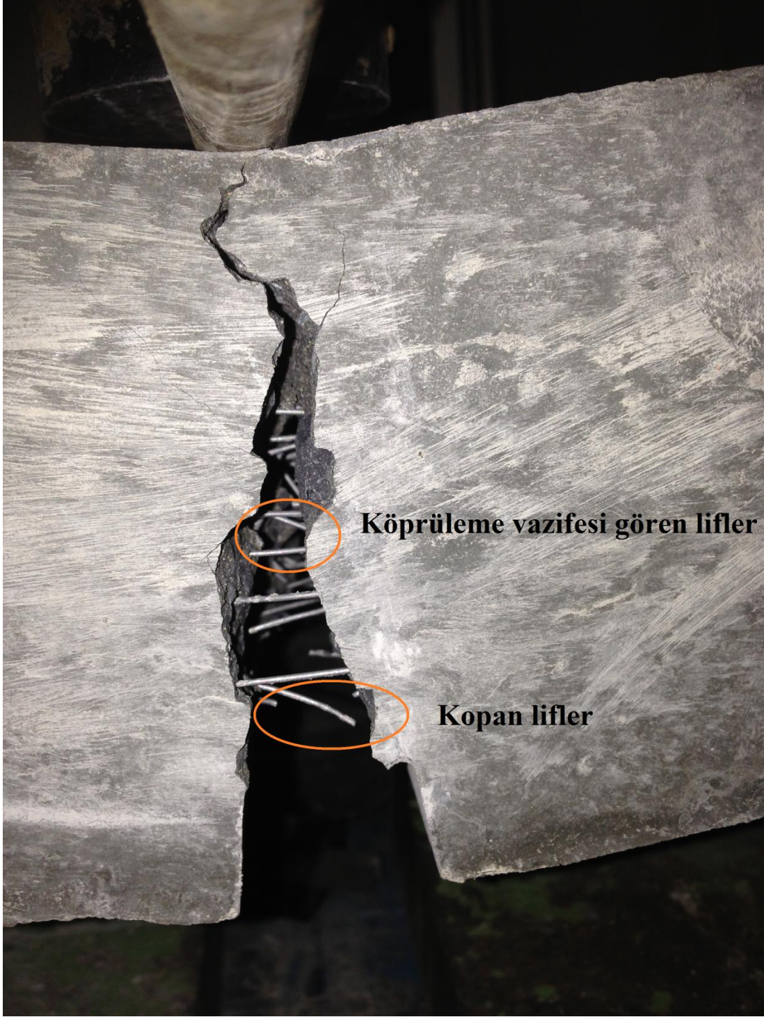
Şekil C.5: Eğilme deneyi sonrası kopan ve köprüleme vazifesi gören liflerin görüntüsü.
