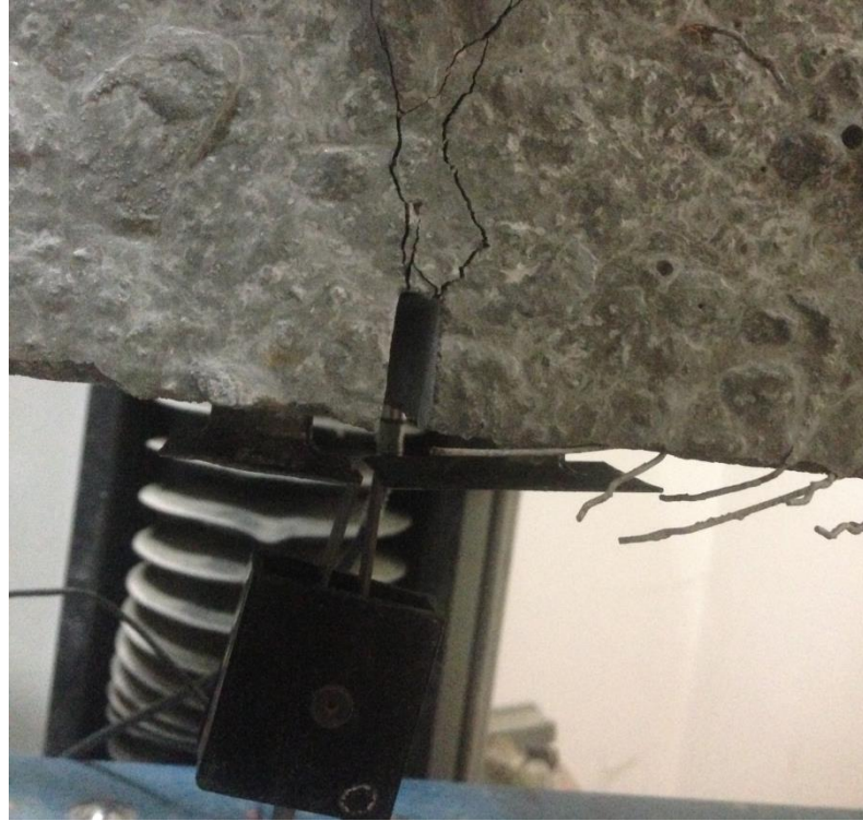
Şekil C.4: Çelik lif içeren bir numunenin eğilme deneyi ve çatlak ağzı açılma deplasmanı ölçer.
