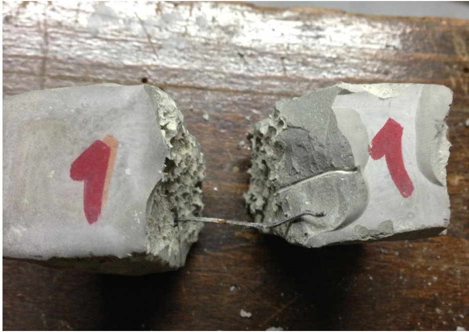
Şekil C.7: Çelik lifin sıyrılmasından önce matrisi dağılan ve elenen bir numune.
