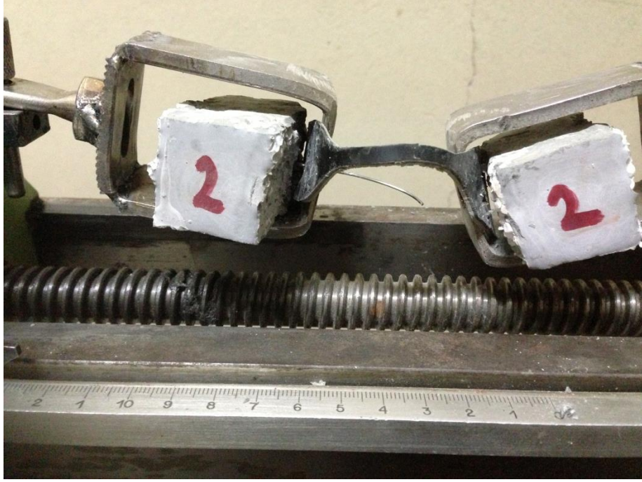
Şekil C.6: Tek bir çelik lif içeren bir numunenin yatay çekme deneyi.
