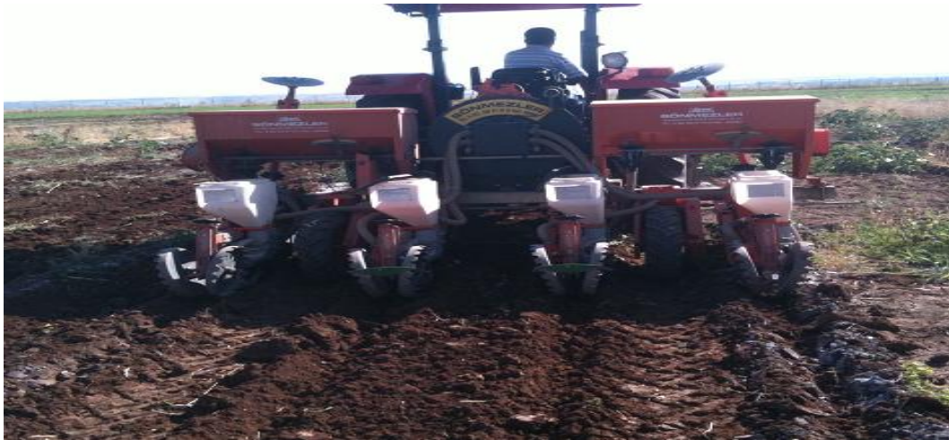
Şekil 3.3. Denemede kullanılan pnömatik ekim makinesi
