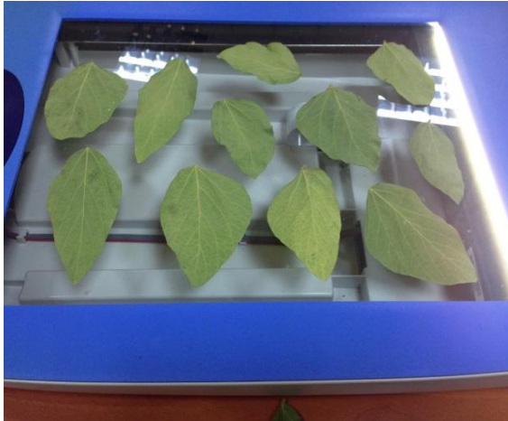
Şekil 5.33. Win FOLIA programı yardımı ile yaprak alanı ölçümü
