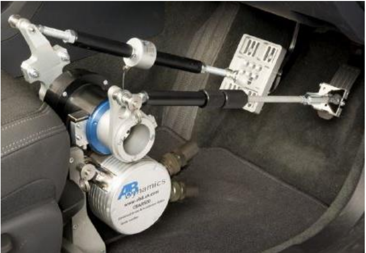
Resim 2.6. Antony Best Dynamics'in geliřtirdiđi gaz ve fren pedalları kontrol sistemi [38]
