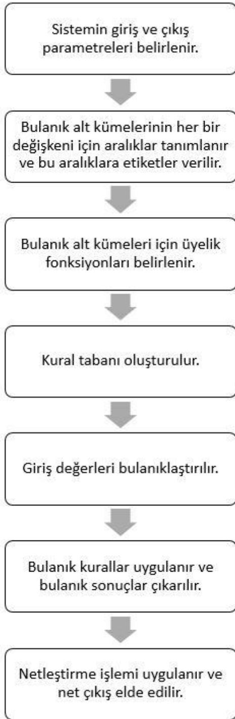
Şekil 3.36. Bulanık mantık uygulama adımlarını anlatan akış diyagramı
