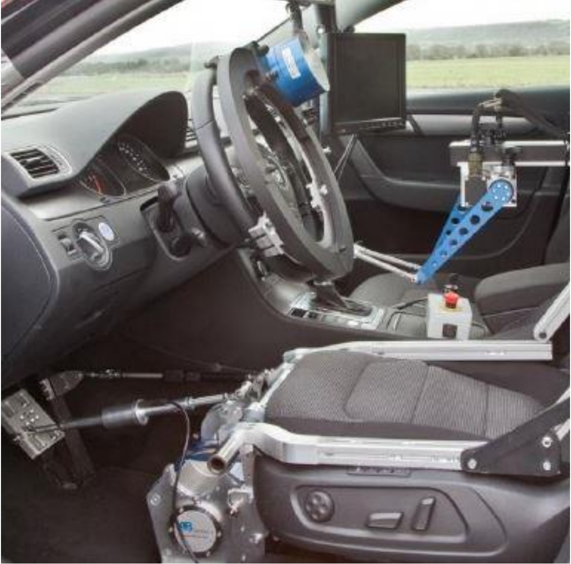
Resim 2.7. AB Dynamics direksiyon, gaz, fren ve vites deęiřtirme sistemleri [38]
