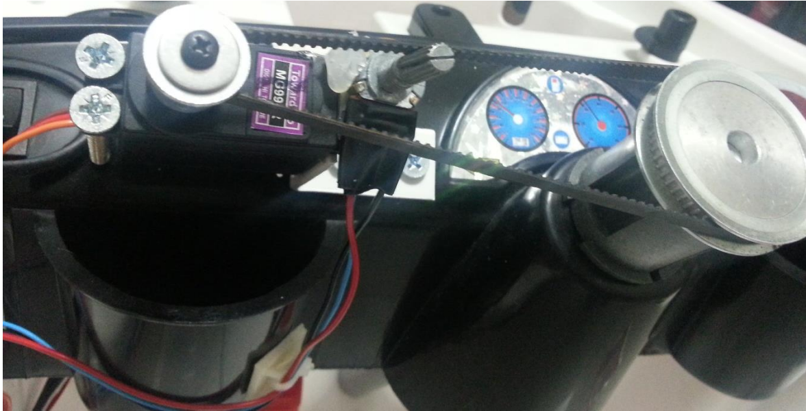
Resim 3.12. Direksiyon yönlendirici sisteme yerleştirilmiş potansiyometre
