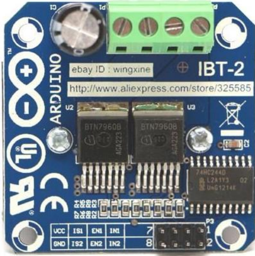
Resim 3.3. BTS7960B motor sürücüsü [41]
