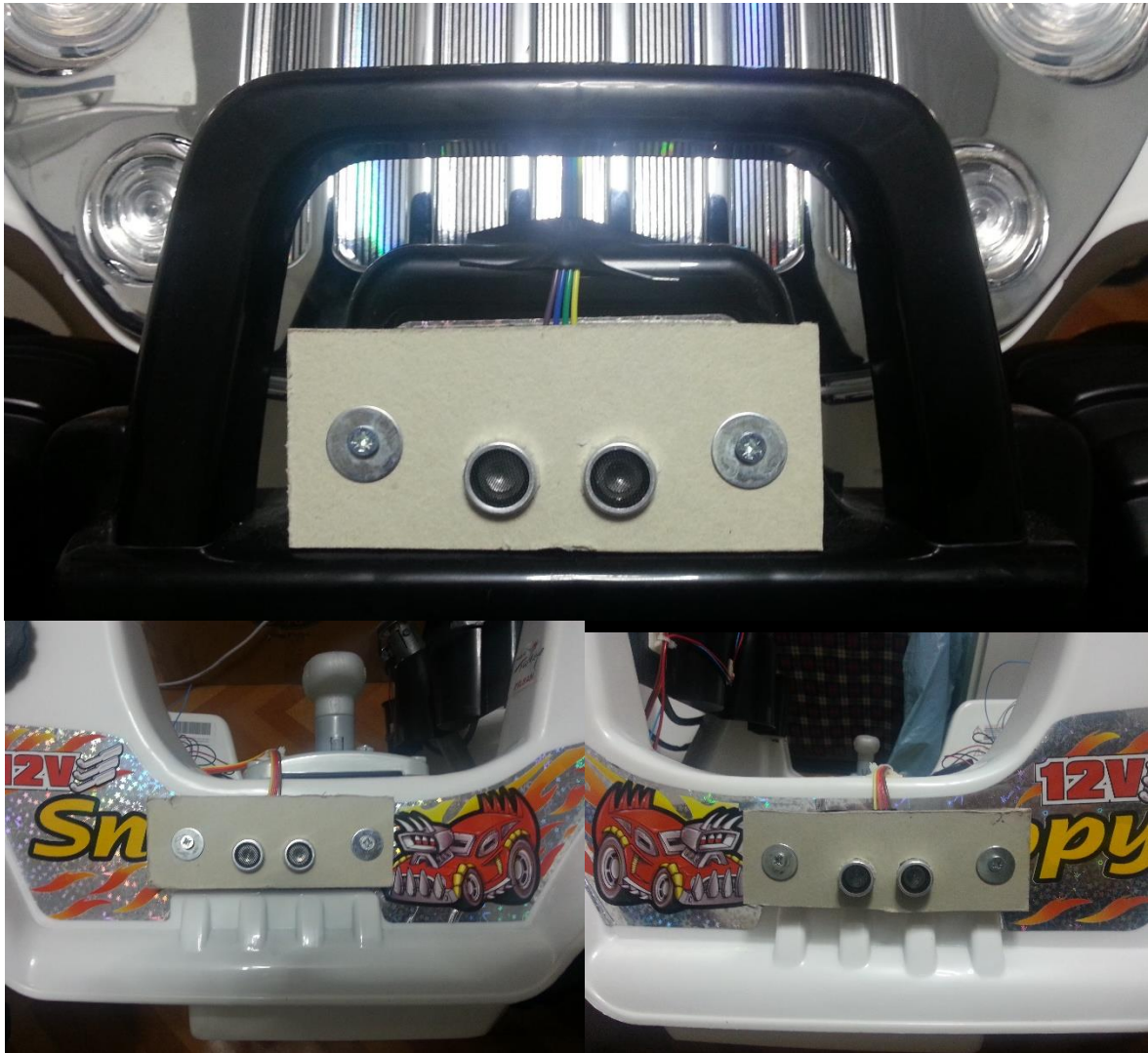
Resim 3.14. Ön sensör (üstte), sağ sensör (solda), sol sensör (sağda)
