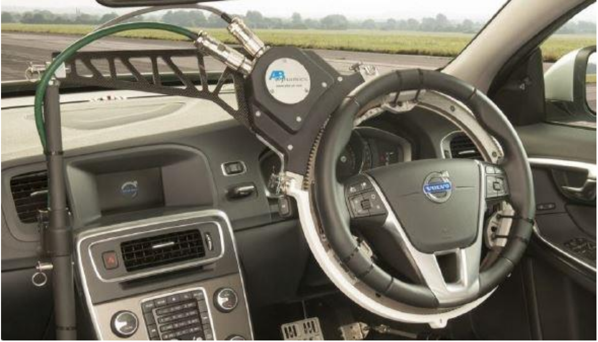
Resim 2.5. Antony Best Dynamics'in geliřtirdiđi direksiyon kontrol sistemi [38]
