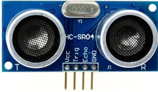
Resim 3.13. HC-SR04 ultrasonik sensör [52]
