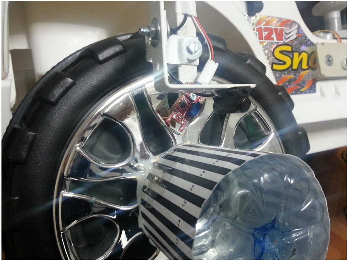
Resim 3.8. Aracın sağ tekeri üzerine inşa edilmiş hız ölçümünü sağlayan kodlayıcı
