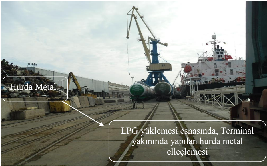
Şekil 4.3 : Tanker terminalinde hurda metal elleçlemesi.
