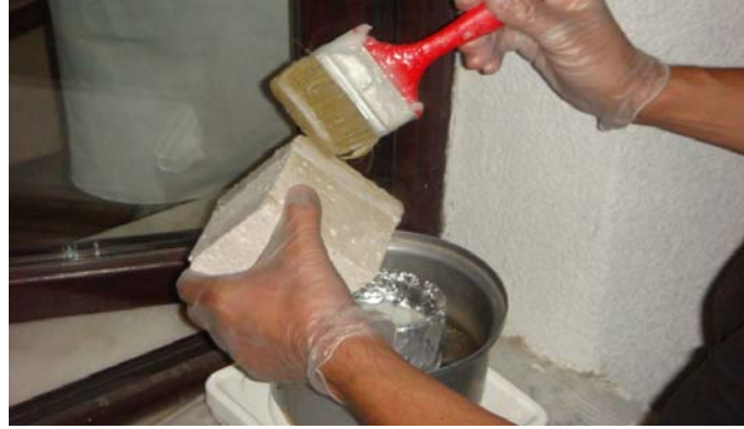
Şekil 3.14. Eritilmiş parafinin numuneye uygulanması
