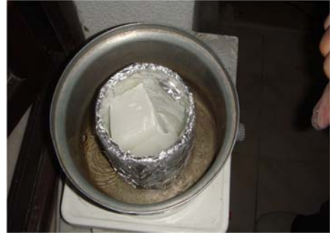
Şekil 3.13. Parafinin benmari yöntemiyle eritilmesi
