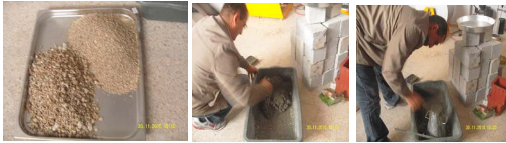
Şekil 3.4. Deneme karışımlarının yapılması
