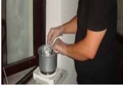
Şekil 3.13. Parafinin benmari yöntemiyle eritilmesi
