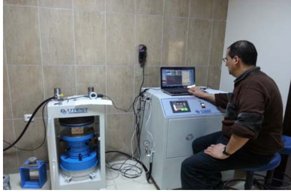
Şekil 3.18. Beton presi ile beton basınç dayanımını belirlenmesi işlemi
