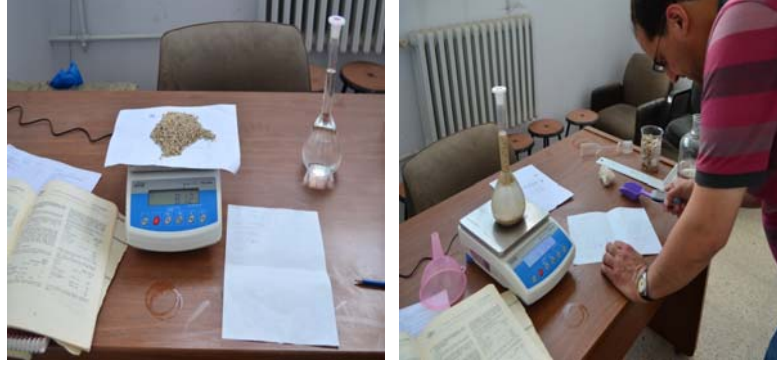
Şekil 3.3. Özgöl ağırlık faktörü deneyi
