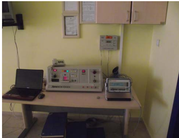
Şekil 3.12. Radyasyon deney düzeneği kontrol paneli ve elektrometre ile yapılan okumalar
