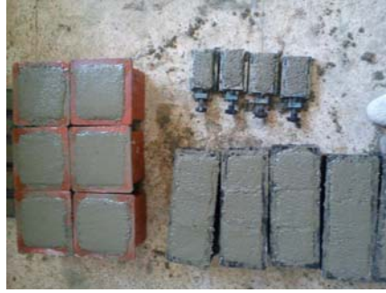
Şekil 3.7. Taze betonun kalıplara yerleştirilmesi (Yaltay ve Ekinci, 2012; Yaltay ve Ekinci, 2013)
