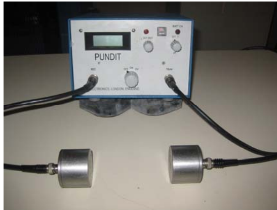
Şekil 3.17. Ultrases geçiş hızı okuma cihazı (Pundit) (Yaltay ve Ekinci, 2012; Yaltay ve Ekinci, 2013)
