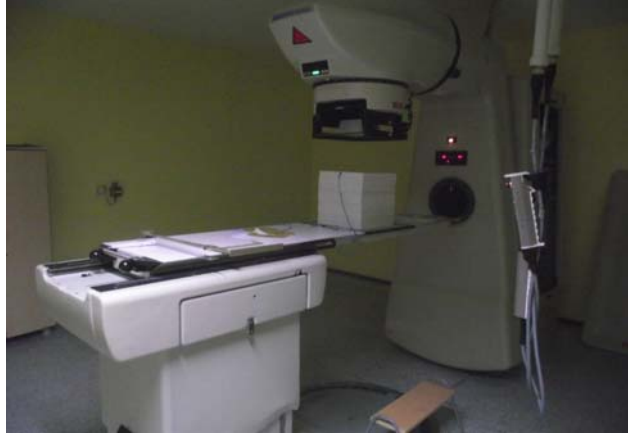
Şekil 3.10. Cobalt 60 radyasyon kaynağı ve radyasyon deney düzeneği
