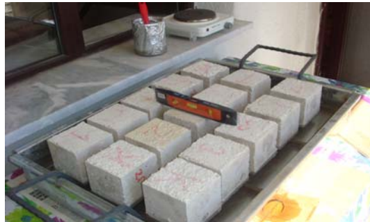
Şekil 3.16. Su emme uygulaması için numune yerleştirilmesi (taban, su seviyesinin 5 mm altında)
