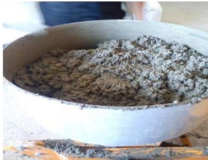
Şekil 3.5. Beton karışımının hazırlanması (pan mikseri)
