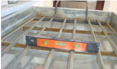
Şekil 3.15. Kapiler su emme deney düzeneğinin tesviye edilmesi
