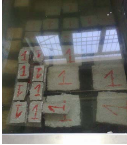
Şekil 3.8. Kalıptan çıkarılan beton numunelerinin kür havuzunda bekletilmesi
