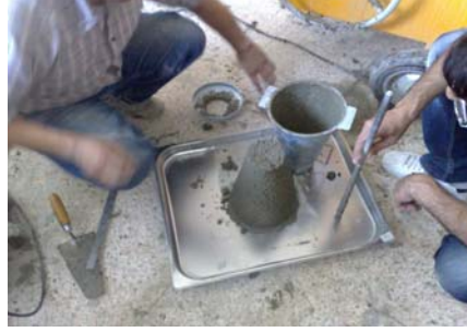
Şekil 3.6. Taze betonda çökme (slump) testi (Yaltay ve Ekinci, 2012; Yaltay ve Ekinci, 2013)
