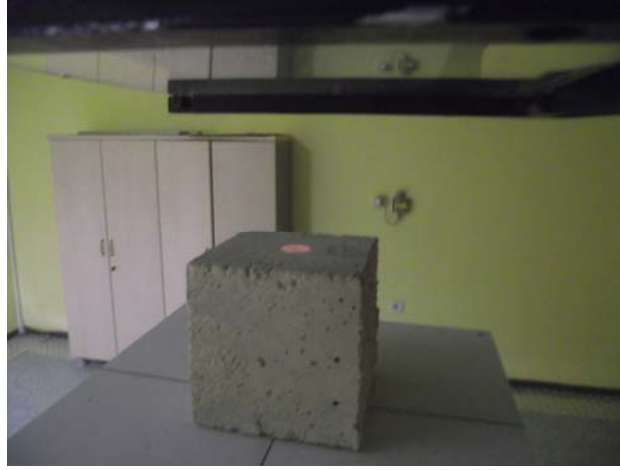
Şekil 3.11. Radyasyon deneyi (Numunenin yerleştirilmesi)
