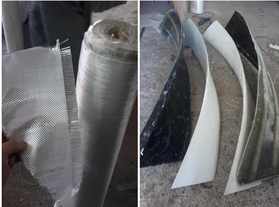
Şekil 4.4. Kanat üretiminde kullanılan cam elyaf; kanat kalıbı, model kanat ve kanat resmi
