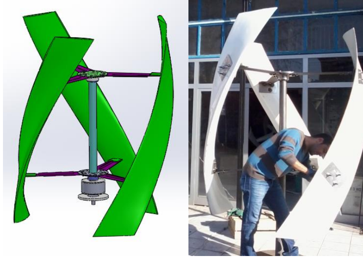
Şekil 4.5. Türbin katı modellemesi ve türbinin montaj anından bir fotoğraf
