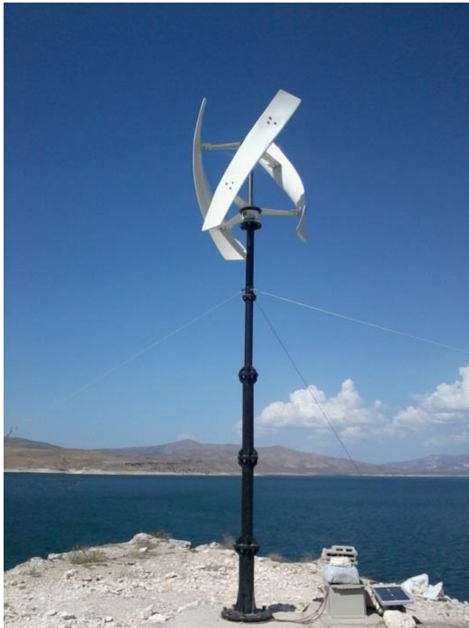
Şekil 4.20. Üretilen ve kurulan helisel Darrieus rüzgâr türbini
