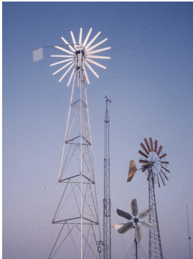
Şekil 1.9. Çok kanatlı rüzgar türbinleri tasarımları
