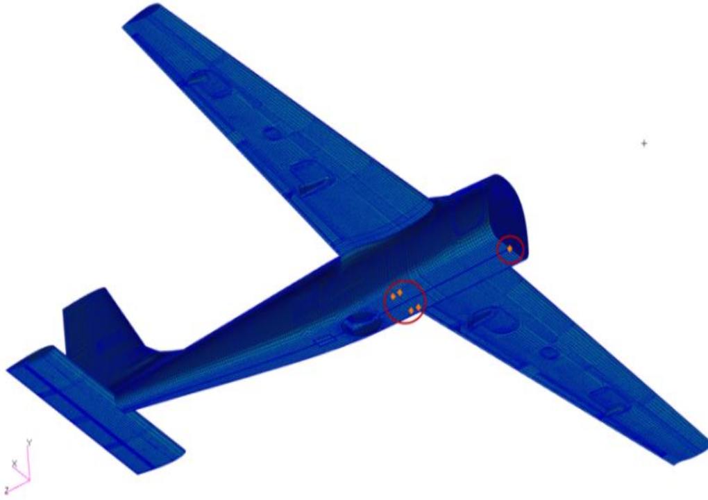
Şekil 3.51: 1g yerçekimi kontrolü için sabitlenen düğüm noktaları.
