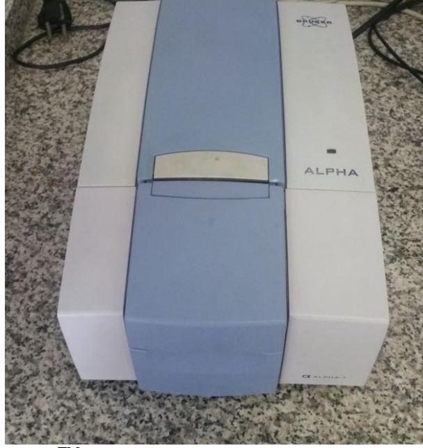
Şekil 3.8 : Bruker TM Alpha-T Fourier transform infrared spektrometresi.
