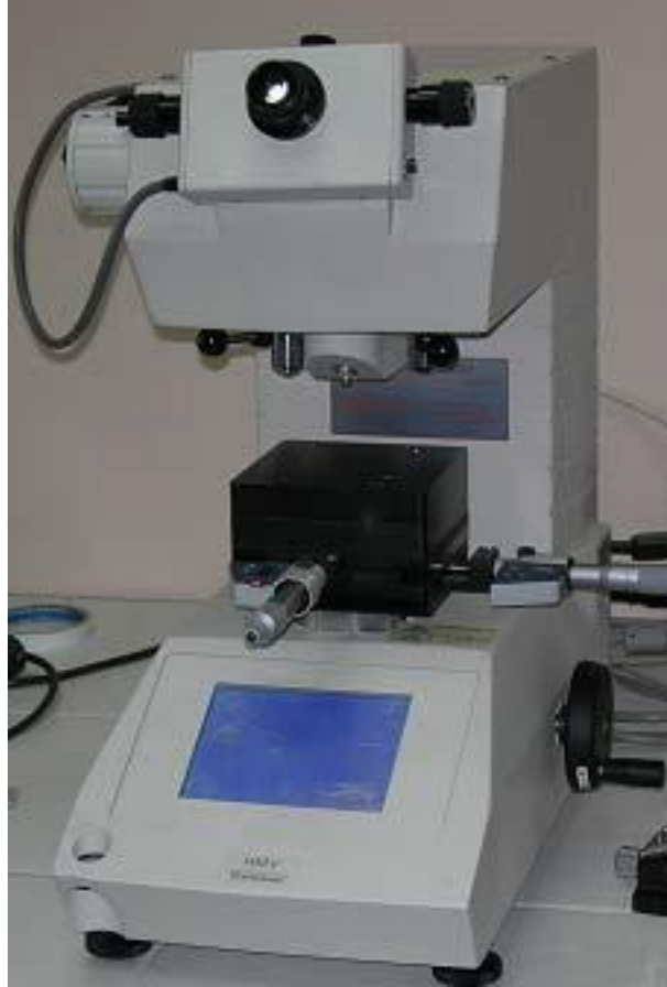
Şekil 3.5 : Shimadzu™ marka HMV-2 mikrosertlik ölçüm cihazı.
