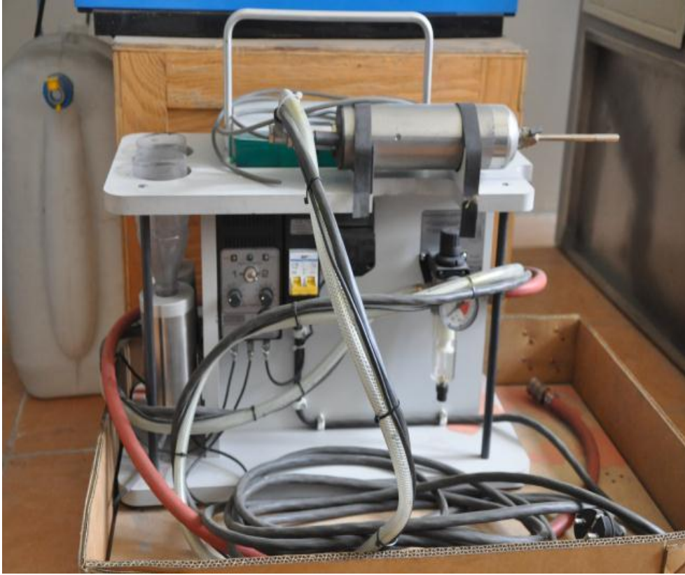
Şekil 3.1 : RUSONIC™ markalı soğuk gaz dinamik püskürtme cihazı.
