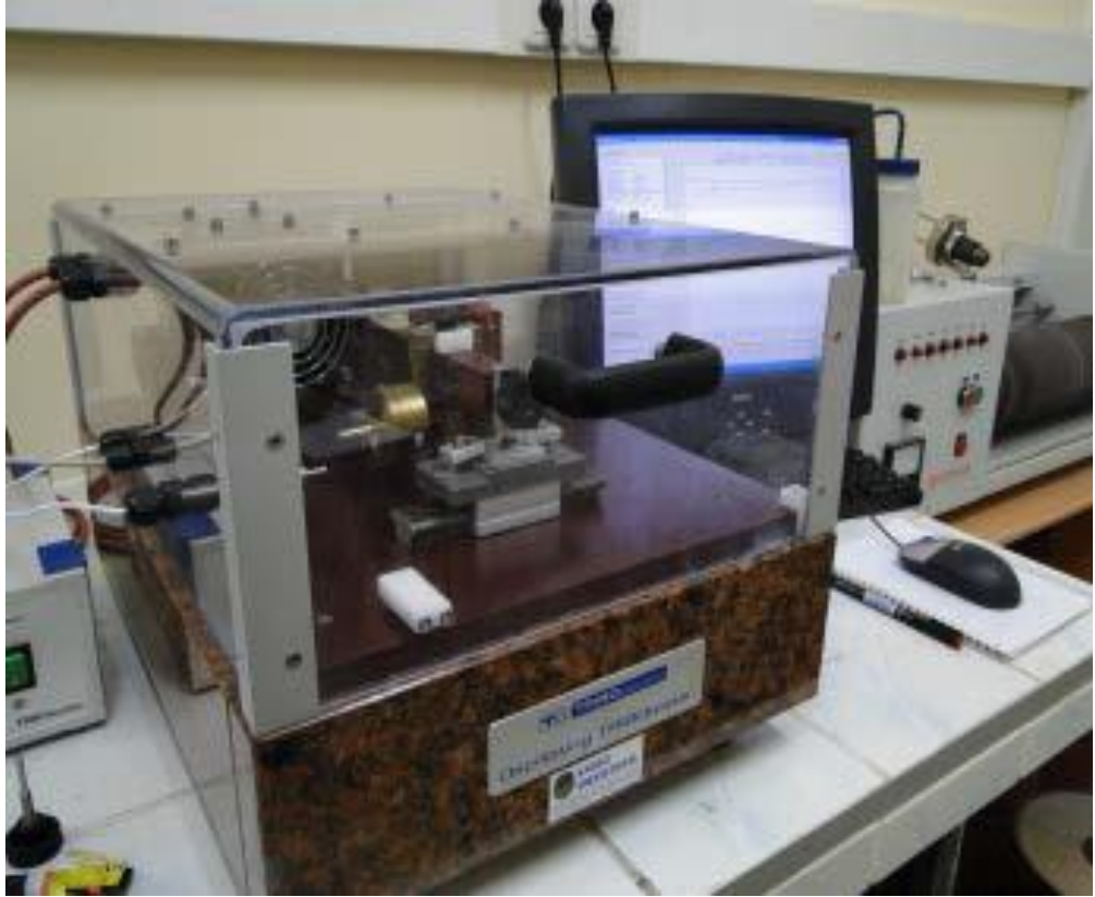
Şekil 3.6 : TRIBOTECH™ marka salınlımlı aşınma cihazı.
