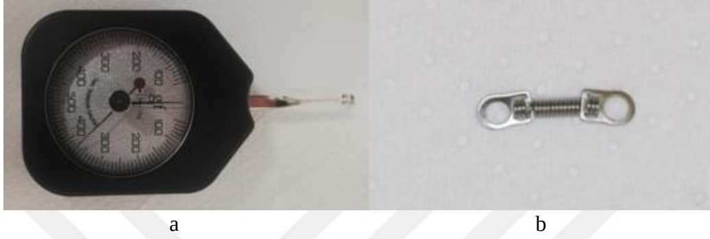
Şekil 3.3. a) Ağız içi kuvvet ölçer b) 9 mm Ni-Ti kapalı yay
