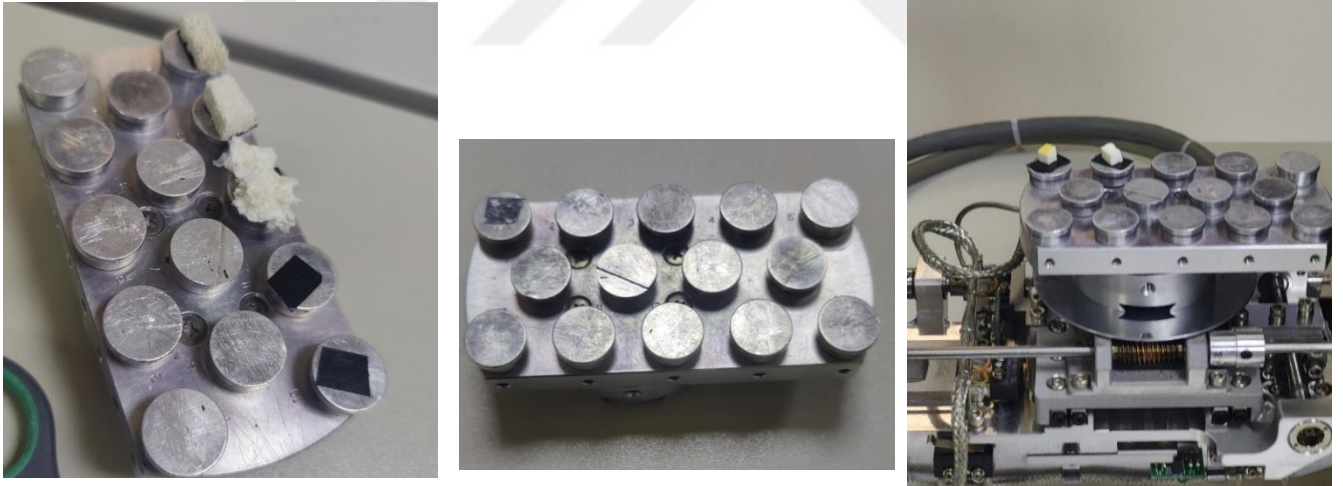
Şekil 3.7 Malzemelerin Sem Cihazında Yer alması (1. Resim katı haldeki HA ve kitosan 2. Görsel Toz haldeki HA ve 3. Görsel iki yüzü farklı malzeme bulunduran kolojen örneği)
