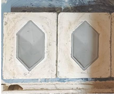
Görsel 3.1: Kalıptan Döküm Alma İşlemi
