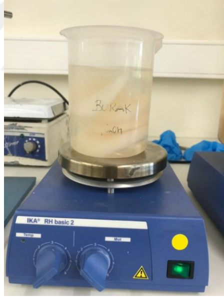
Şekil 4. 3 NaOH çözeltisi içerisinde bakteriyel selülozun ağartma işlemi
