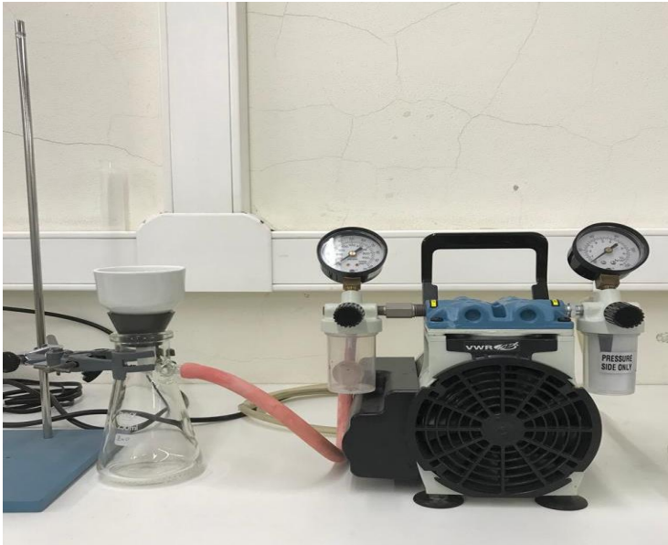
Şekil 4. 5 Hava Basınçlı Filtreleme Sistemi
