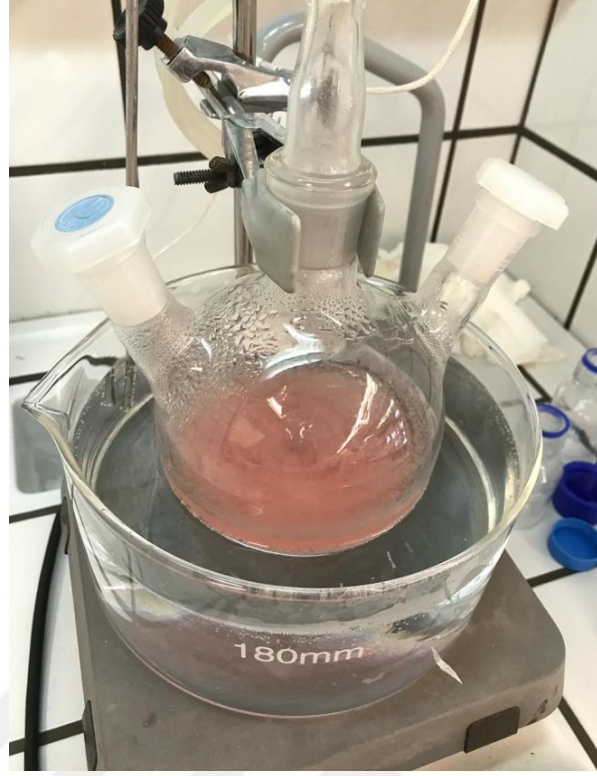
Şekil 4. 4 Üç boyunlu balonda bakır oksit sentezi
