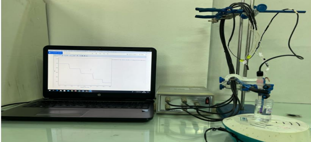
Şekil 3.1 Bilgisayar kontrollü potansiyometrik ölçüm sistemi
