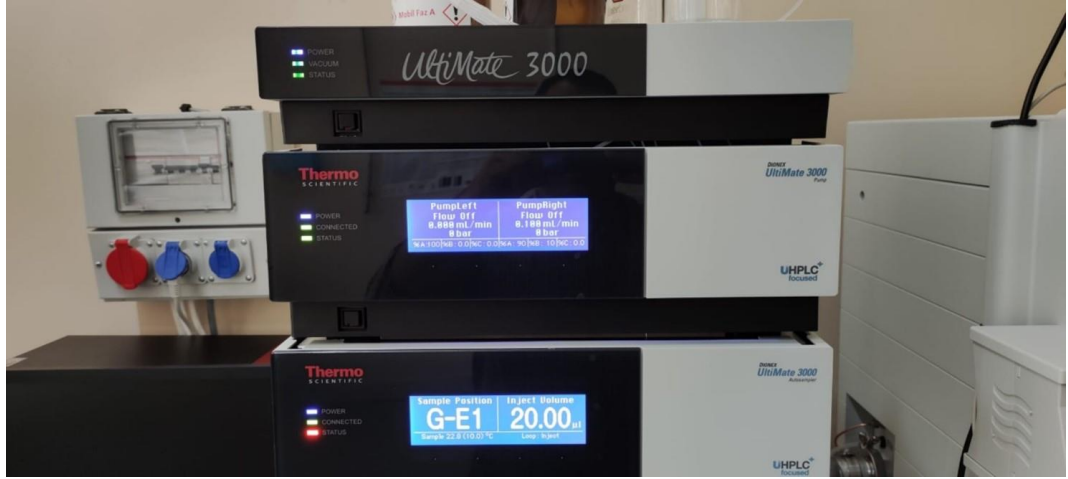
Şekil 3. 1. K vitamini ölçümlerinde kullanılan Ultimate 3000 UHPLC analizörü.
