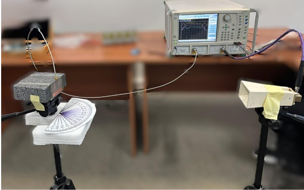
Şekil 4.3 Üretimi yapılan antenlerin ölçüm düzeneği
