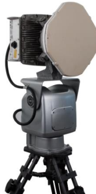
Şekil 1.6 Pan-tilt unit anten örneği
