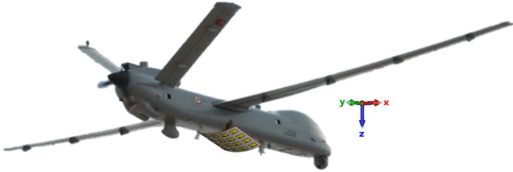
Şekil 1.9 Hava aracı prototip anten yerleşim görseli
