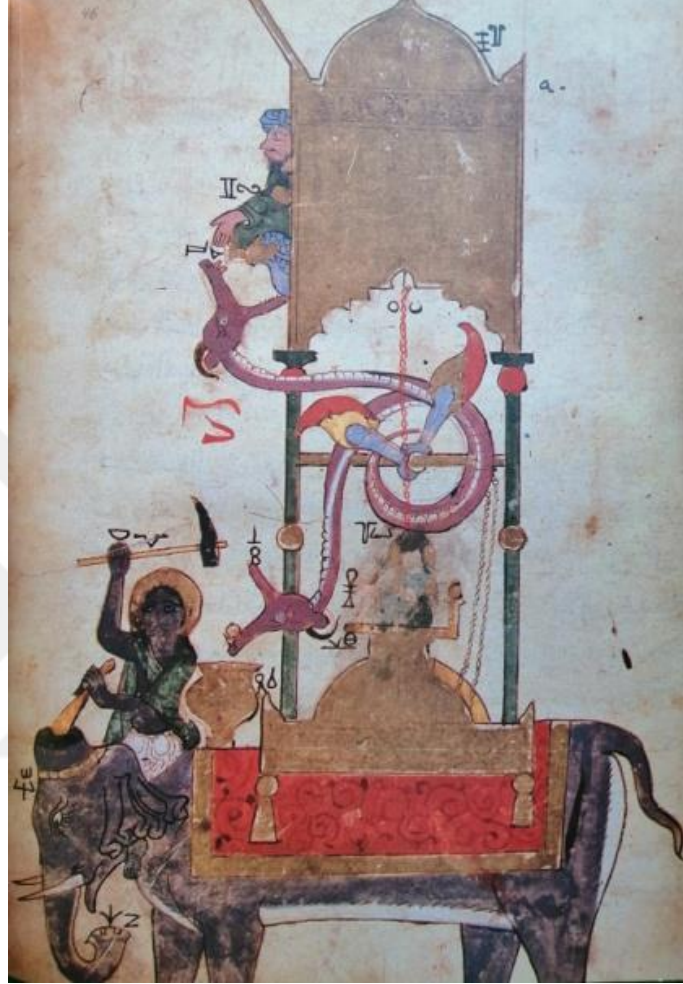
Görsel 7. El Cezeri,1206, Filleri Su Saati, (El Cezeri, Olağanüstü Mekanik Araçların Bilgisi Hakkında Kitap, y.46)
