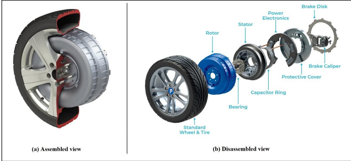
Şekil 3.3. Protean-Pd18-TiM model tasarımı genel bakışı (URL-1).
