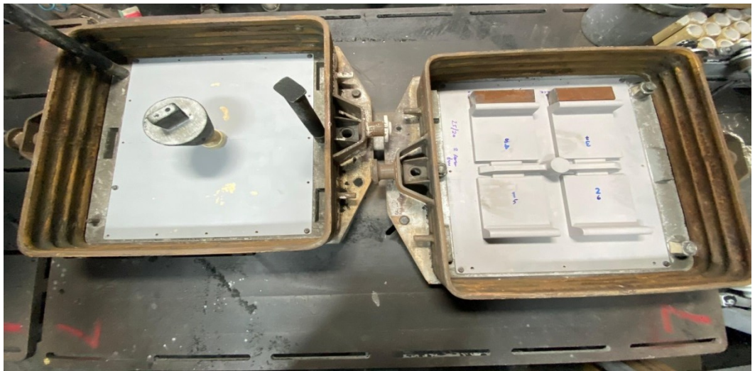
Şekil 5.2 : Plaka modelin derece içindeki dikey yolluk ve soğutuculu yerleşimine ait fotoğraf.
