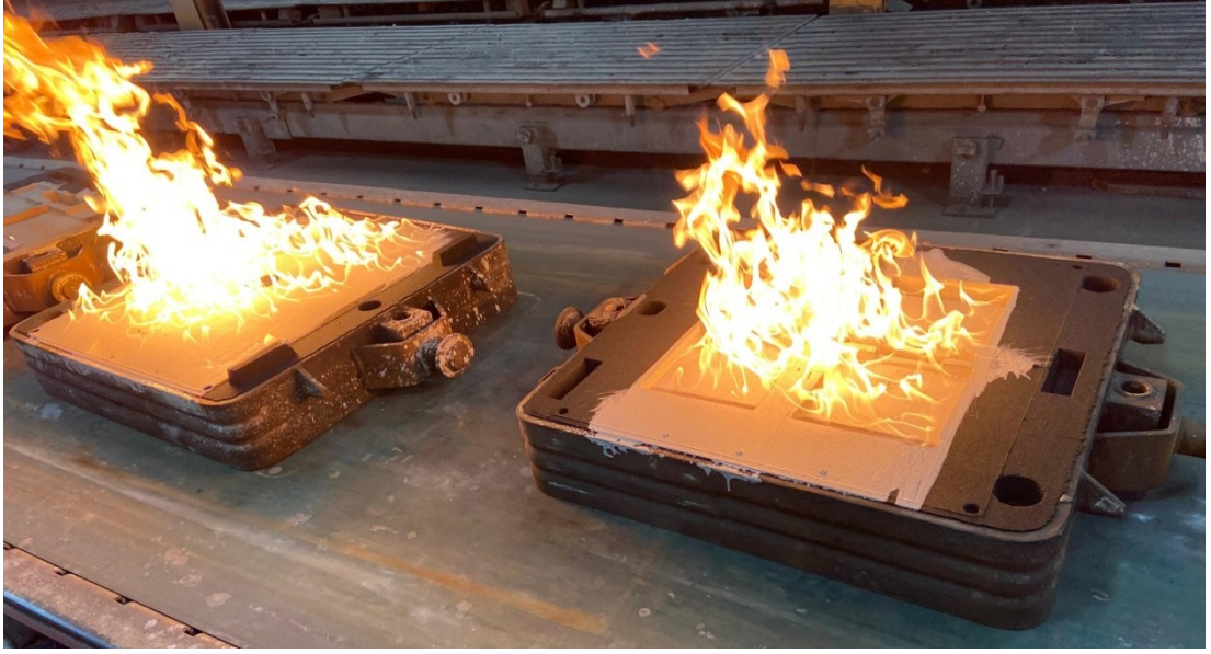
Şekil 5.5 : Kum kalıpların boyandıktan sonra yakılarak boyanın kurutulması.
