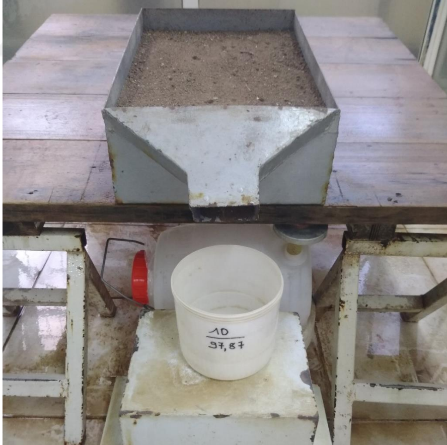
Şekil 3. 7. Tülbent bezinin üzerine toprak örneği doldurulması ve %9'luk eğim tablası üzerine yerleştirilmesi
