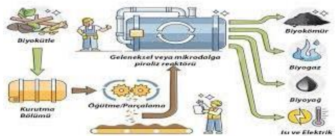
Şekil 2. 1. Biyokömür üretim şeması (Carrillo, 2021)
