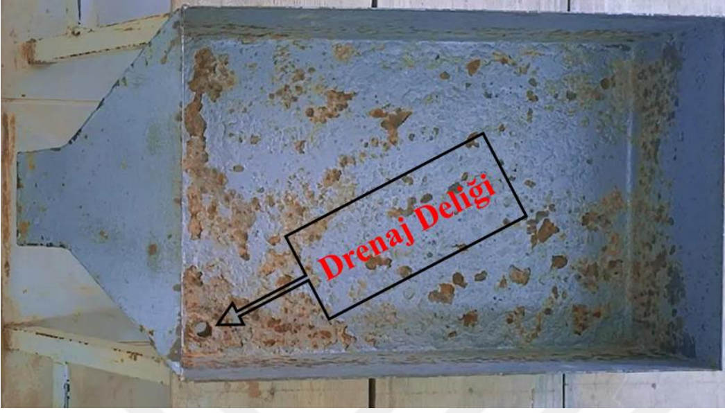
Şekil 3. 4. Araştırmada kullanılan metal erozyon parseli
