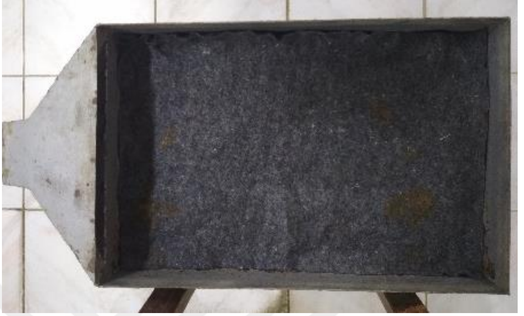
Şekil 3. 6. Düzetilmiş çakıl tabakası yüzeyine tülbent bezi serilmesi
