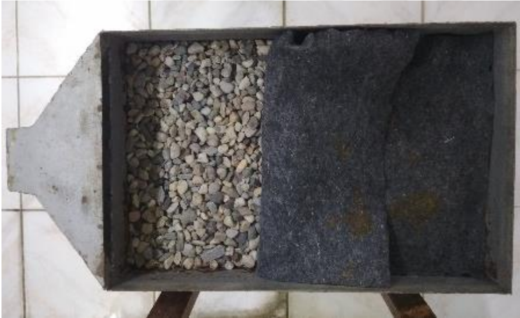
Şekil 3. 4. Araştırmada kullanılan metal erozyon parseli
