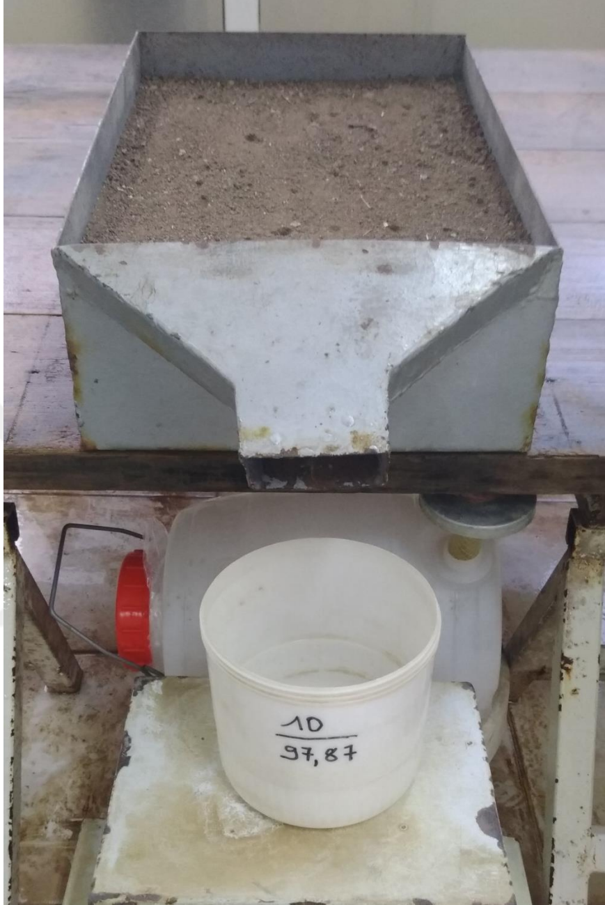
Şekil 3. 17. Drenaj, yüzey akış ve toprak kayıplarının belirlenmek deneme düzeneği
