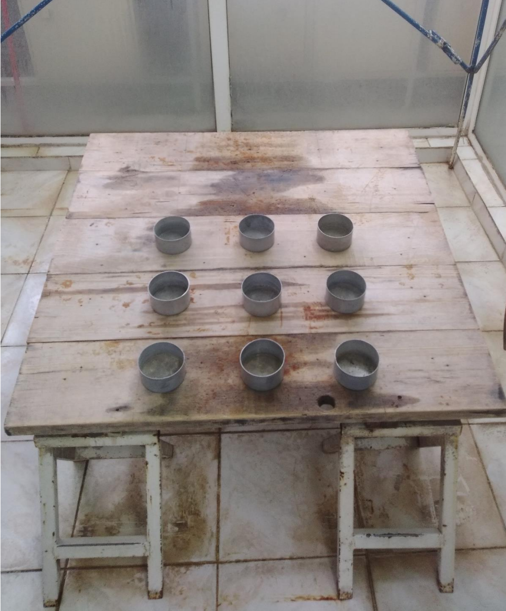
Şekil 3. 14. Araştırmada kullanılan %9'luk eğim tablasının görüntüsü
