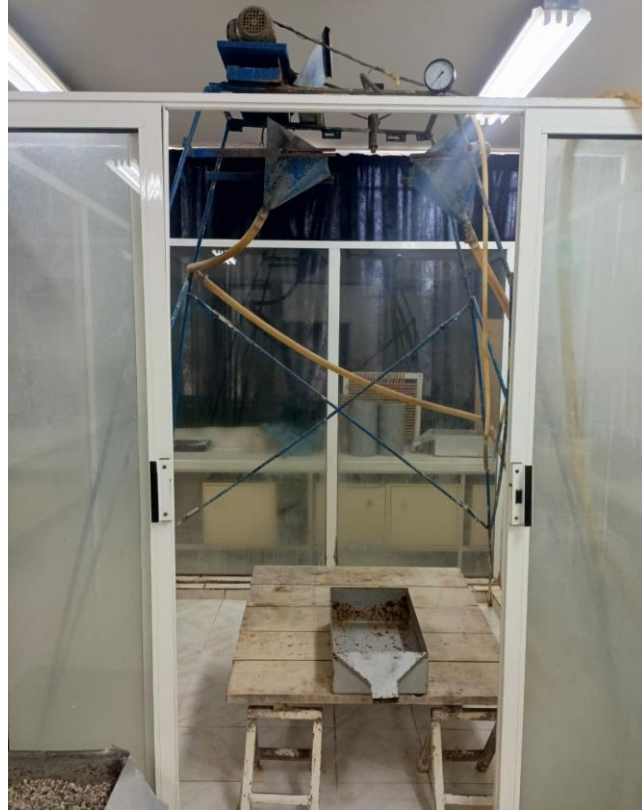
Şekil 3. 16. Araştırmada kullanılan yağış benzeticinin görüntüsü
