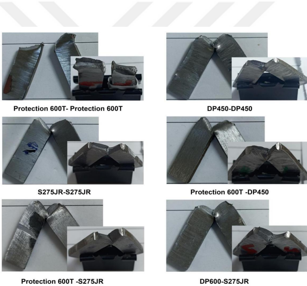
Şekil 4.3 Darbe çentik sonrası seçilen numunelerin kırılma yüzeyleri.
