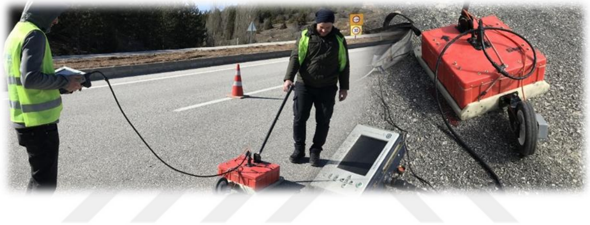
Şekil 20. Yer radarı ölçümlerinde kullanılan GSSI marka SIR3000 radar cihazı
