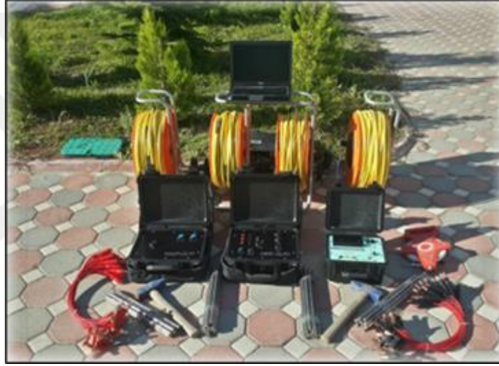
Şekil 22. Çok elektrotlu elektrik özdirenç tomografi ölçüm ekipmanı
