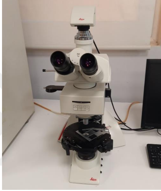
Resim 3.8 Optik mikroskop cihazı
