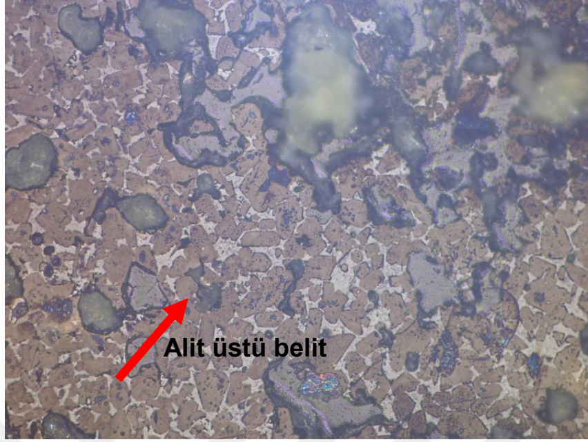
Şekil 4.5 %25 oranında ömrünü tamamlamış lastik yakılarak üretilen klinker (20x) alit üstü belit görüntüsü
