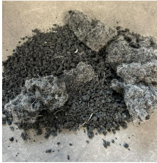
Resim 3.4 Ömrünü tamamlamış lastik numunesinin öğütülmüş hali
