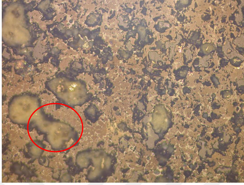
Şekil 4.7 %25 oranında ömrünü tamamlamış lastik yakılarak üretilen klinkere ait ayrılmamış faz dağılımı (20x)
