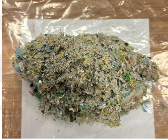
Resim 3.3 Atık ambalaj numunesinin öğütülmüş hali
