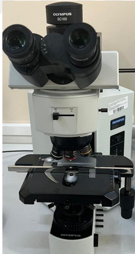
Şekil 4.15 Numunelerin Olympus marka optik mikroskobu ile görüntülenmesi
