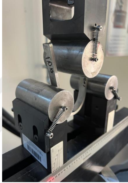
Şekil 4.9 MTS test cihazında üç nokta eğme testi ile 180° eğme uygulanan numune
