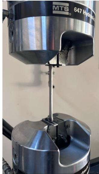
Şekil 4.3 Çekme testi için yerleştirilen numune
