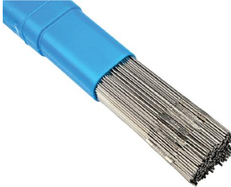
Şekil 3.3 Deneyisel çalışma için kullanılan ER316L TIG ilave kaynak teli
