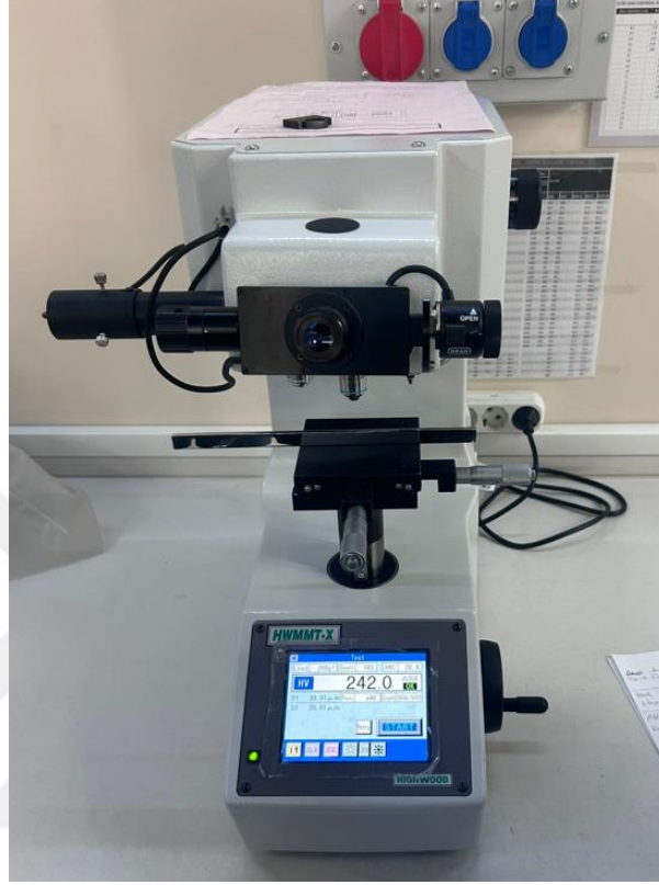
Şekil 3.11 HWMMT-X3 Vickers sertlik ölçüm cihazı görüntüsü
