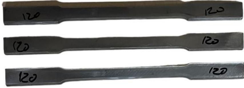
Şekil 4.1 Çekme testi için 120 amperde hazırlanmış 3 adet numune
