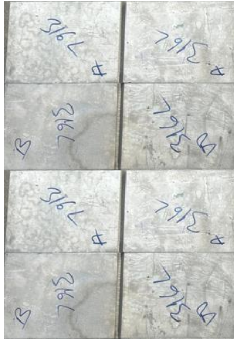
Şekil 3.4 Fiber lazer kesim makinesinde kesilip kaynak için hazırlanan plakalar
