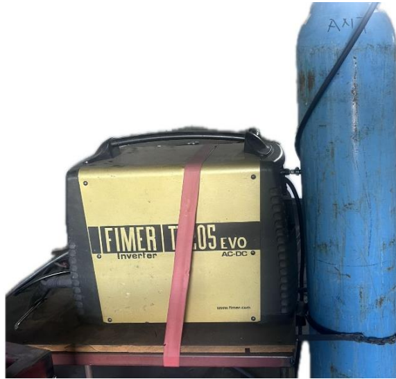
Şekil 3.1 Deneyisel çalışma için kullanılan TIG kaynak makinesi Fimer TT205 İnverter AC-DC
