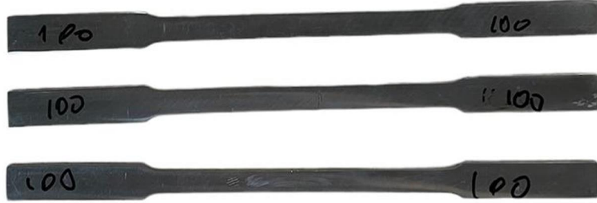
Şekil 4.2 Çekme testi için 100 amperde hazırlanmış 3 adet numune
