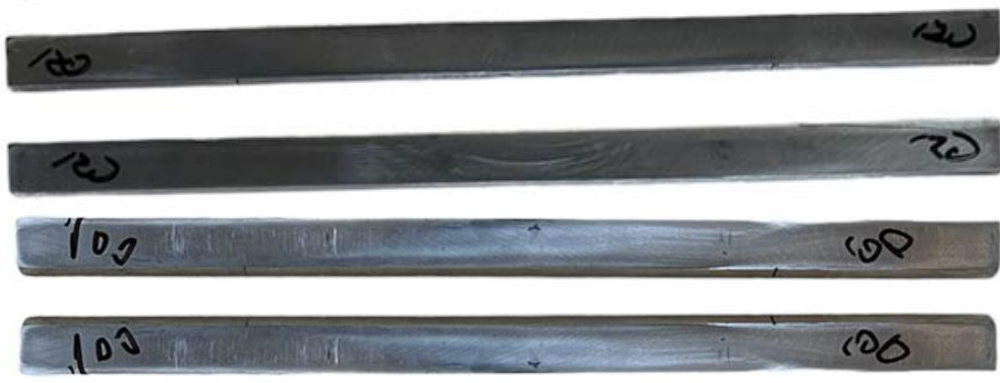
Şekil 4.8 120 ve 100 amper kaynaklı hazırlanmış numunelerin görüntüleri
