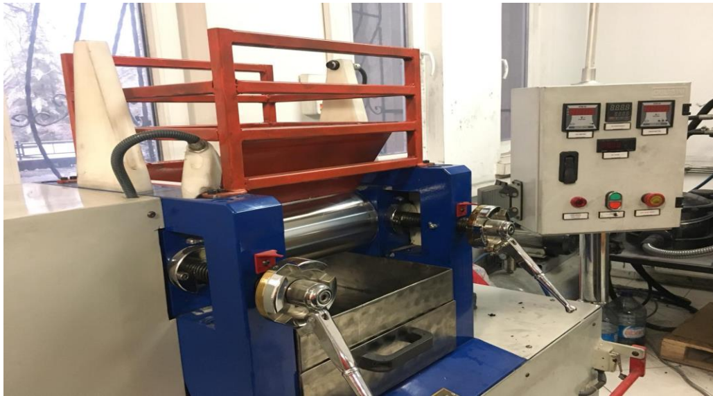
Şekil 3.2. Karışımların hazırlanmasında kullanılan Elkim marka 2 milli karıştırıcı
