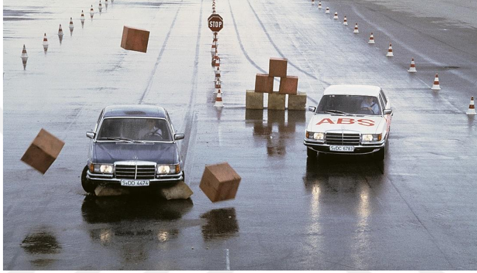
Şekil 1. Mercedes-Benz'in W116 S-serisi yolcu otomobilinde ABS testleri, (Daimler 2024)
