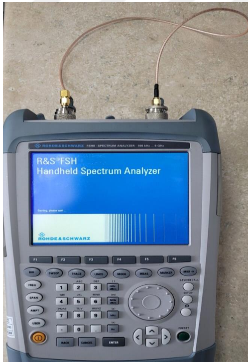
Şekil 4.4 RG 316 kablonun spektrum analizöre bağlantısı
