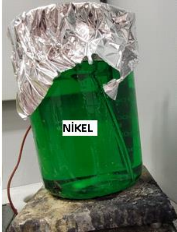
Şekil 3.4. Akımsız nikel kaplama solüsyonu
