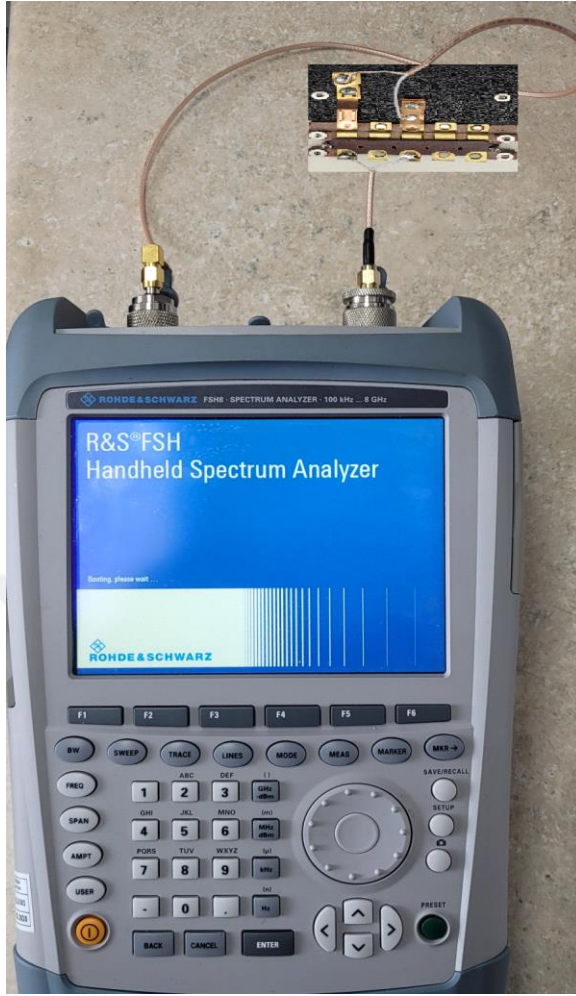
Şekil 4.8. RG316 kablo + BNC + sabit hareketli kontak test düzeneği
