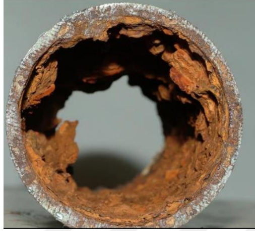
Şekil 5. Çökelti korozyona uğramış metal yüzey[15]
