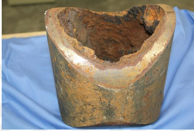
Şekil 8. Grafitik korozyona uğramış metal yüzey [20]
