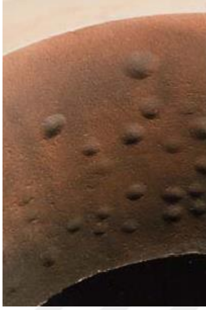
Şekil 10. Hidrojen birikimine uğramış metal yüzey[23]
