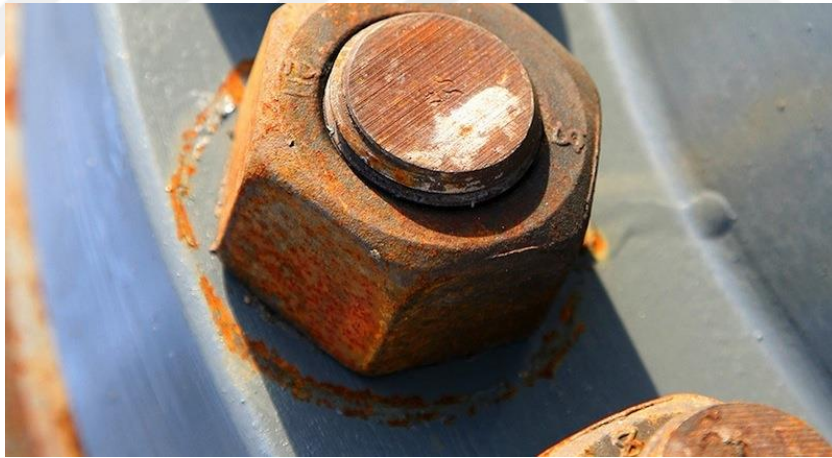
Şekil 4. Galvanik korozyona uğramış metal yüzey [14]
