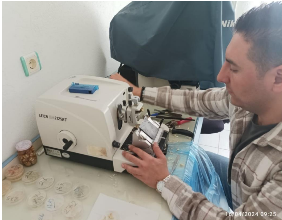
Şekil 3.27. Rotary mikrotomunda enine kesit örneklerinin alınması
