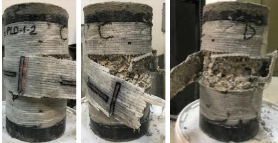
Şekil 5.4: ELCS-PLD-M-1 numunelerinin yükleme sonrasındaki görünümü .
