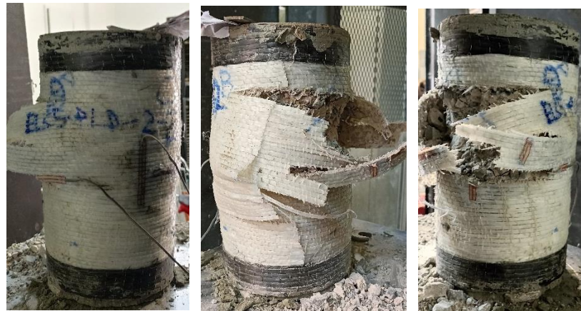
Şekil 5.12: ELCS-PLD-2-C numunelerinin yükleme sonrasındaki görünüşleri .
