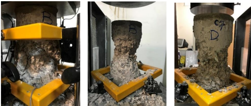
Şekil 5.2: REF-ELCS-M numunelerinin deney sonrası görünüşleri .
