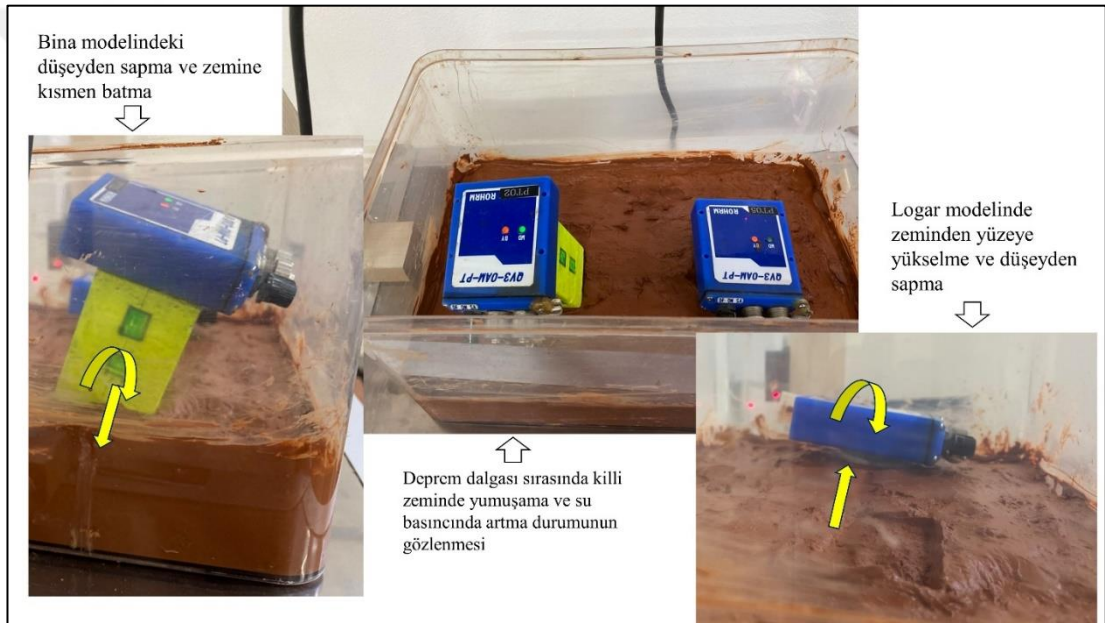
Şekil 7.10: Sıvılaşma modeli deneyi sonrasında bina ve logar modellerinin konumlarının görünümü.
