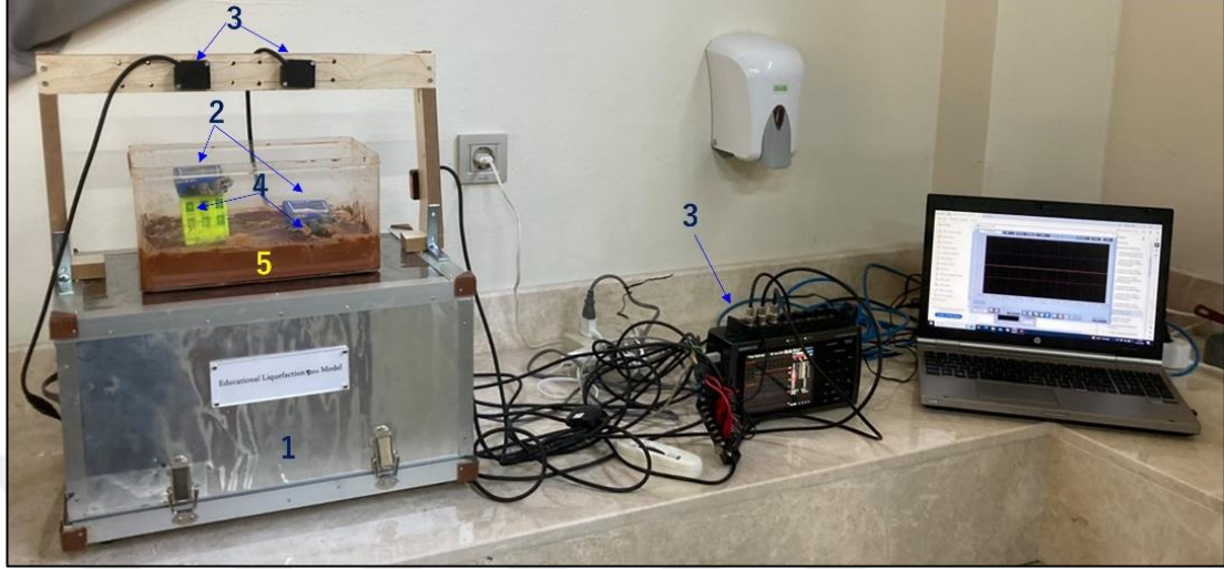
Şekil 7.8: Killi zeminlerin sıvılaştırma model deneyi düzeneği
