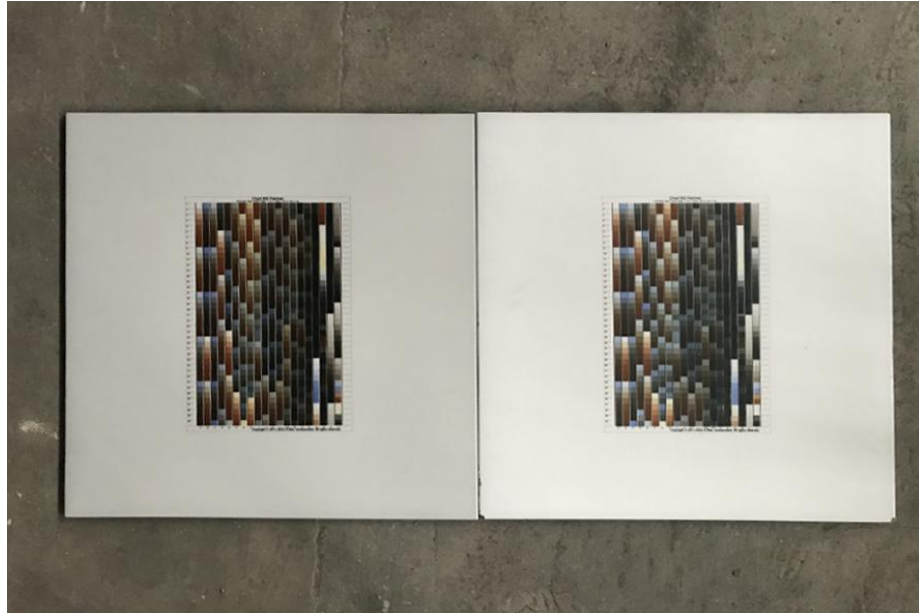
Resim 2.74: Hazırlanan Renk Skalasının Farklı Sırlarda Basılmış Halleri
