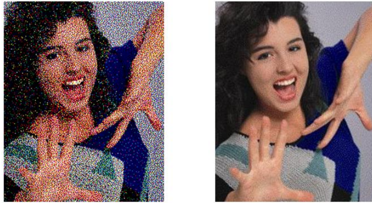
Resim 2.22 : Binary (Sol) ve GS (Sağ) Baskı Görüntüleri
