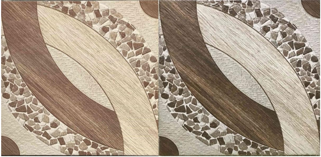
Resim 2.30: Rölyefli Karonun Baskılı Ham (Sağ) ve Pişmiş (Sol) Halleri
