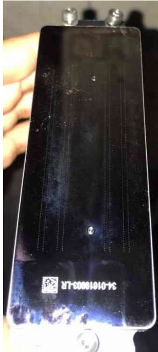
Resim 2.91: Dimatix SG1024 1C Başlığı Nozul Görüntüsü
