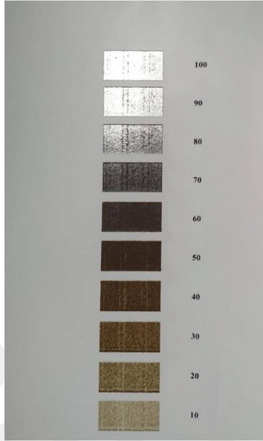
Resim 2.105: Metalik Efekt Mürekkebin Karo Yüzeyine Kademeli olarak %10'luk Atım Gösterimi
