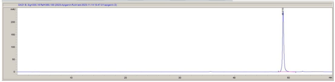
Şekil 9. Standart apigenin HPLC kromatogramı ( R_T = 49.7 dakika )
