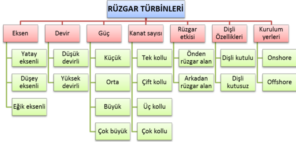
Şekil 1.2. Rüzgâr Türbini Sınıflandırılması (Elibüyük ve Üçgül, 2014)
