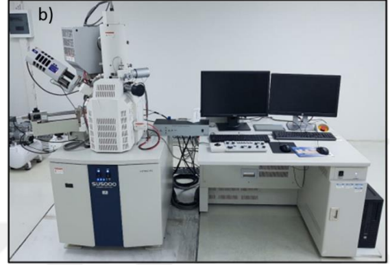
Şekil 3.17 a) SEM sisteminin şematik gösterimi (Narin 2021) b) Hitachi SU 5000 FE-SEM sistemi
