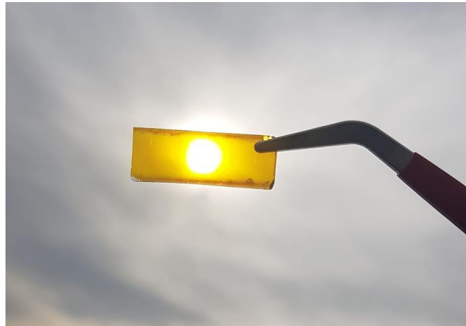
Şekil 2.2 Mikroskop camı üzerine sis-CVD ile büyütülen \text{Cu}_2\text{O} ince filmi
